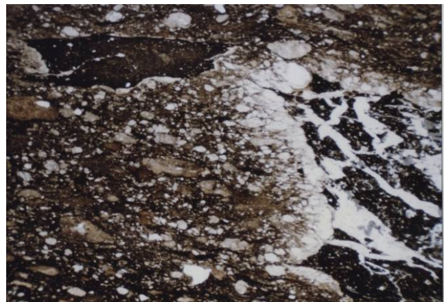
Abb. 3-17: In „Graupen“-tonstein eingeschlossene Pelitfragmente, die durch kohlige Substanzen fast opak sind, zahlreiche feine Quarzkörnchen enthalten und beim Zerschneiden mit feinstem hell transparentem Schlamm durchsetzt werden. Durchlicht - Hellfeld, Bildlängskante 6 mm
