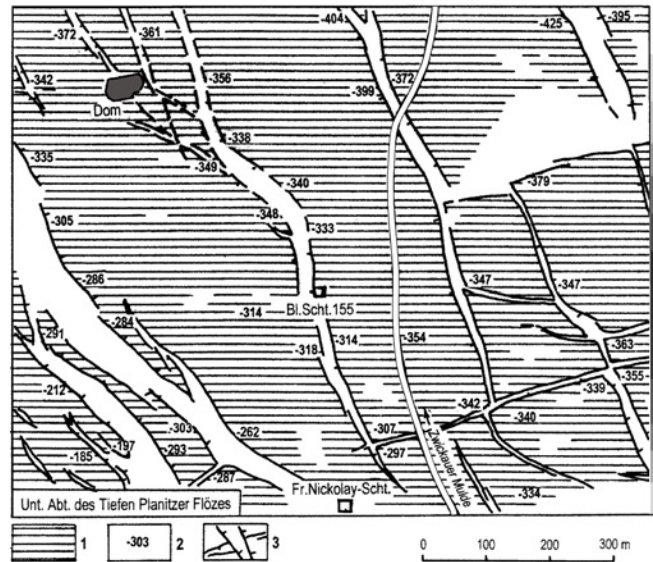
Abb. 6-2: Ausschnitt Flözriss Amandus-Flöz 1 - abgebaute Flözfläche; 2 - Höhenangabe (m NN) für Flözbasis; 3 - Bruchstörungenzone, flözleer
