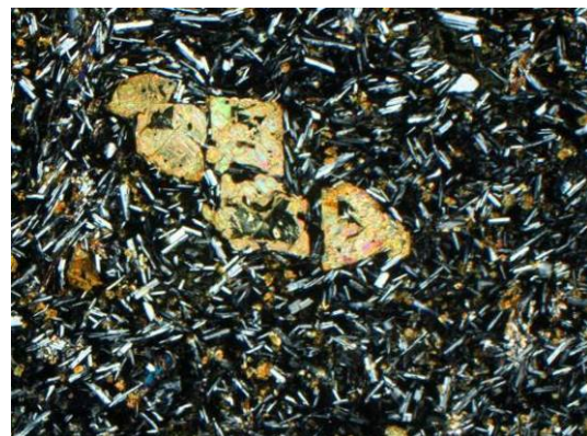
Abb. 3-25a, b: Übersichtsaufnahme des Cainsdorf-Planitzer „Melaphyrs“, mit II Nicols links (25a) und x Nicols rechts (25b). Zu erkennen sind die intersertalen Plagioklasleisten mit einigen alterierten Olivinpseudomorphosen (DS: 124.71 - Fundort: Cainsdorf). Lange Bildkante jeweils 0,4 mm. Archiv LfULG-Freiberg
