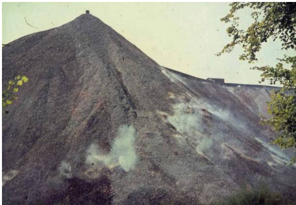
Abb. 9-2: Kegelförmige Halde Zw 32 mit Haldenbrand (Foto: M. WÜNSCHE)
