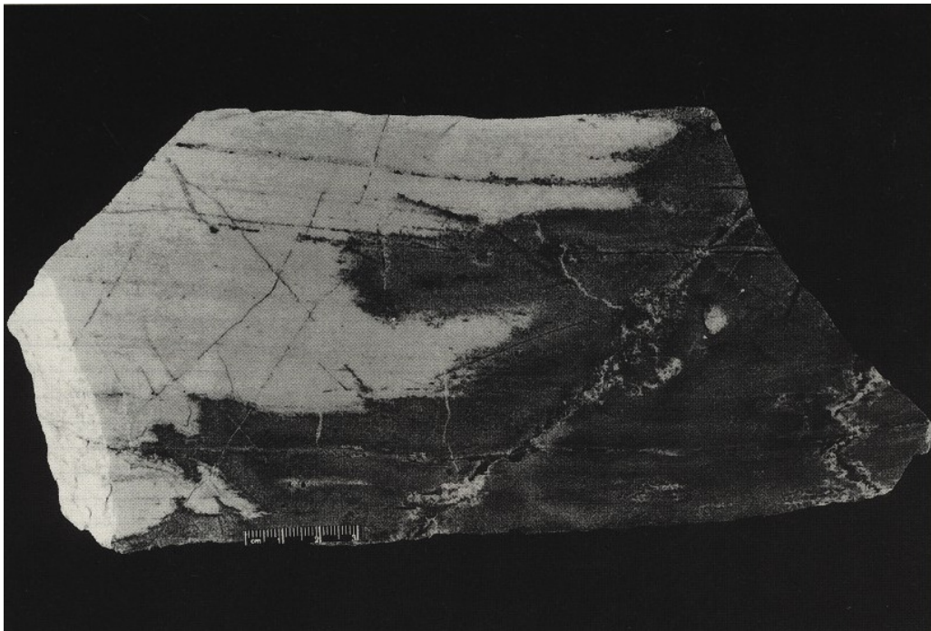
Abb. 13: Metasomatische Verdrängung von Dolomit durch Magnetit Foto: LfUG
