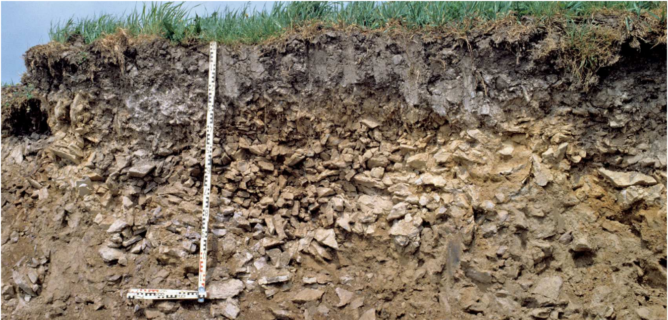
Abb. 10: Podsol aus flachem Schuttlehme über Lehmschutt aus Rhyolith südwestlich von Schmiedeberg
