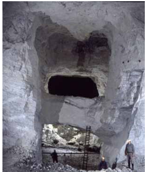
Abb. 71: Lagerstätte Hermsdorf, Kammer-Pfeiler-Abbau aus jüngerer Zeit (Foto: J. KUGLER)
