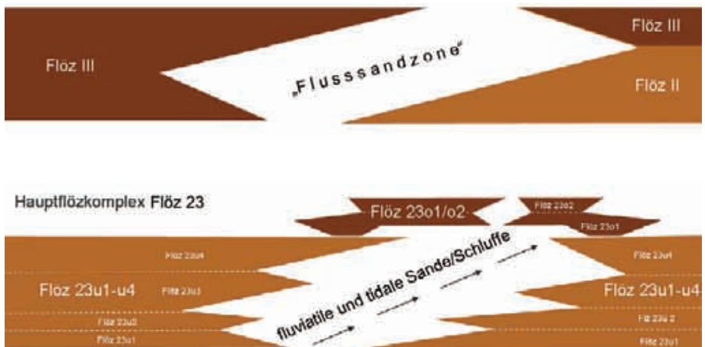
Abb. 6.1.4: Stratigraphische Lagerungsverhältnisse der Flöze 2 und 3 nach PIETZSCH (1925), MEYER (1951) und EISSMANN (1970, 1994, 2005) (oben) und Modell des Hauptflözkomplexes nach RASCHER et al. (2006, 2008).
