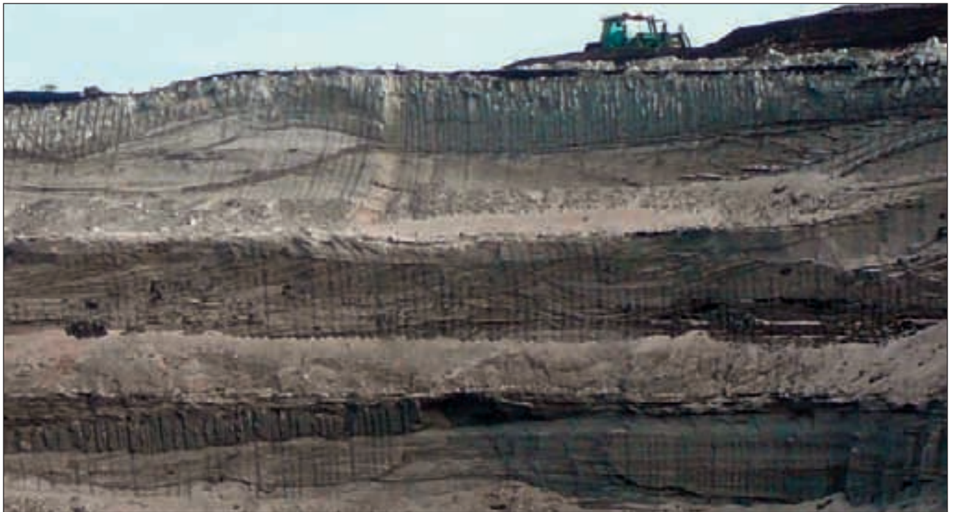
Abb. 4.3.4: Fluvial-ästuarine Sande (Ältere Zeitzer Flussande, Hauptgrundwasserleiter GWL 5) zwischen Unterflöz und Hauptflözkomplex; im oberen Teil deutliche Rinnenstrukturen, darüber Luckenauer Ton, Tgb. Profen (Foto: G. Standke, 2002).
