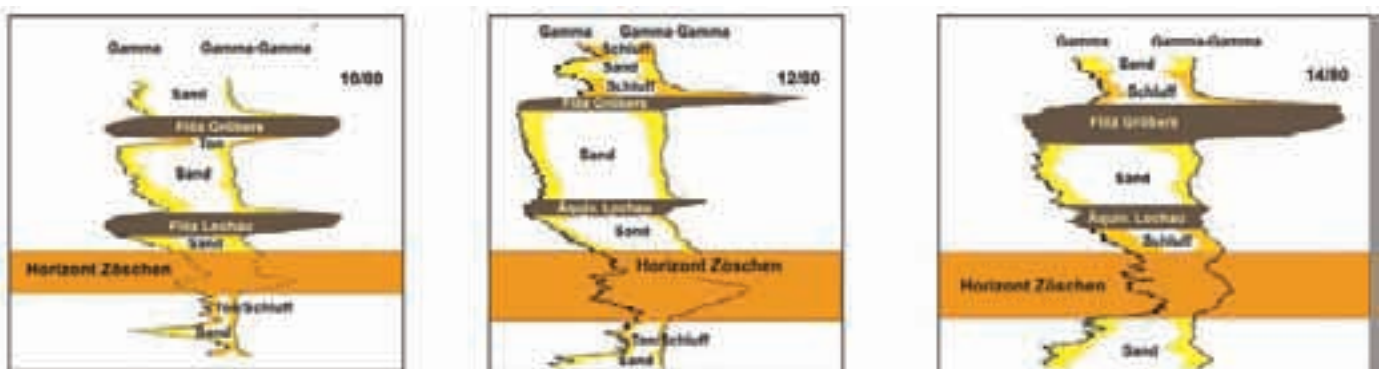
Abb. 4.4.25: Auskeilen von Flöz Lochau in den Lochau-Sanden (i. S. v. BLUMENSTENGEL et al. 1996, 1999) nach bohrlochgeophysikalischen Messkurven.
