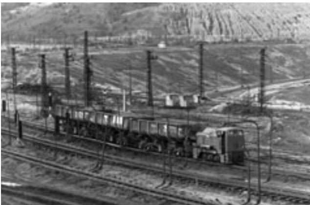
Abb. 5-6-10: Diesellok V 10c mit Abraumwagen im Tagebau Schleenhain (Foto: POKSCHEWINSKI)
