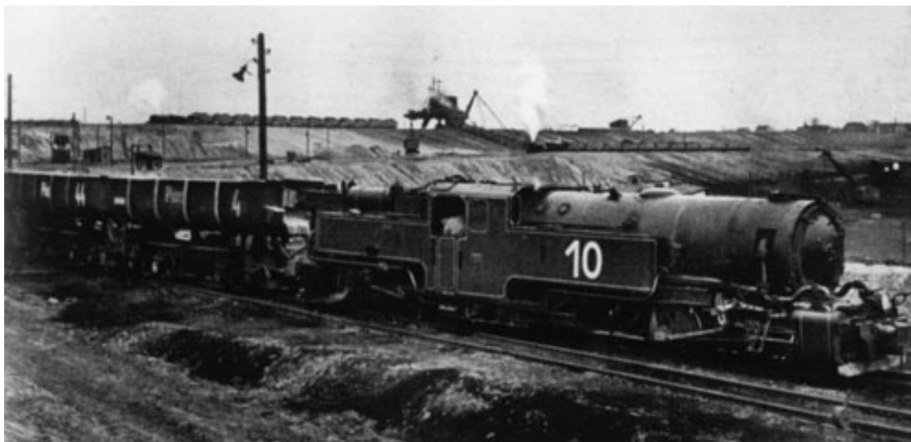
Abb. 5-6-7: Drei Henschel-Gelenk-Lokomotiven im Betrieb der Grube Phoenix (Foto: Werkaufnahme HENSCHEL)
