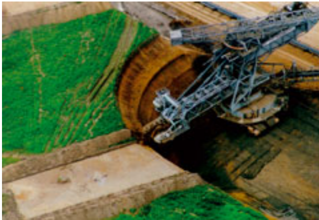
Abb. 5-2-48: Bagger 1522 SRs 1300 im Blockvertrieb
