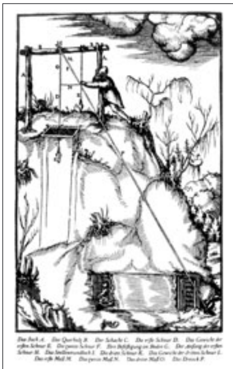
Abb. 7-3-1: Bestimmung der solitären Länge und der Seigerteufe nach Agricola
