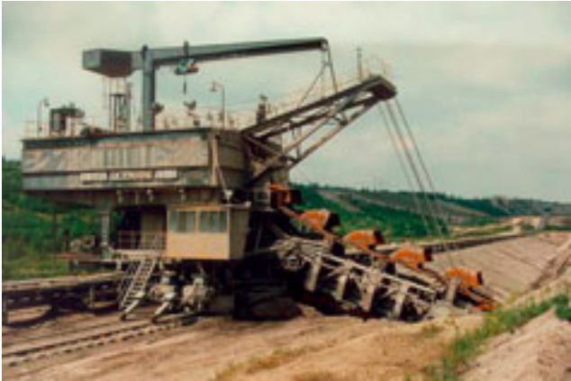
Abb. 5-2-41: Grabenschöpfer 1317 G 1600 Tagebau Espenhain
