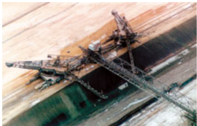
Abb. 5-2-28: AFB 18 im Tagebau Zwenkau mit den Baggern 624 und 625 Es 1600
