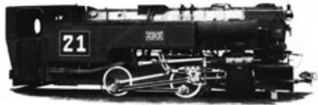
Abb. 4-5-7: „B“-Nassdampf-Tenderlokomotive mit Einsatz ab 1929 in den DEA-Tagebauen der Oberbergdirektion Altenburg (Foto: Archiv BRÄUTIGAM)
