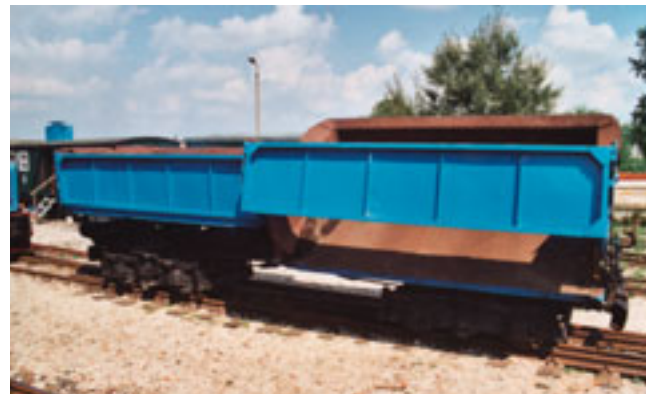
Abb. 5-6-4: 2x7,5-m 3 -Doppelkastenkipper (Foto: KIRCHHÜBEL)
