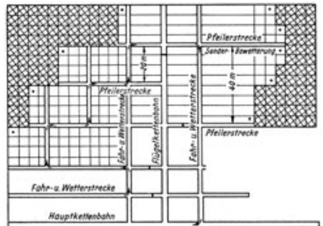
Abb. 5-1-7: Feldeseinteilung (Ausrichtung) beim Pfeilerbruchbau (links) und im Rießerverfahren (rechts)
