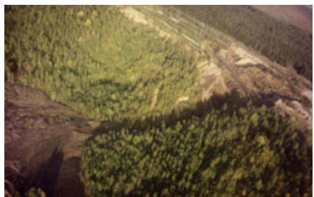
Abb. 7-8-15: Die Fließrutschung im Tagebau Zwenkau vom 01.04.1994 (Foto: BERKNER)
