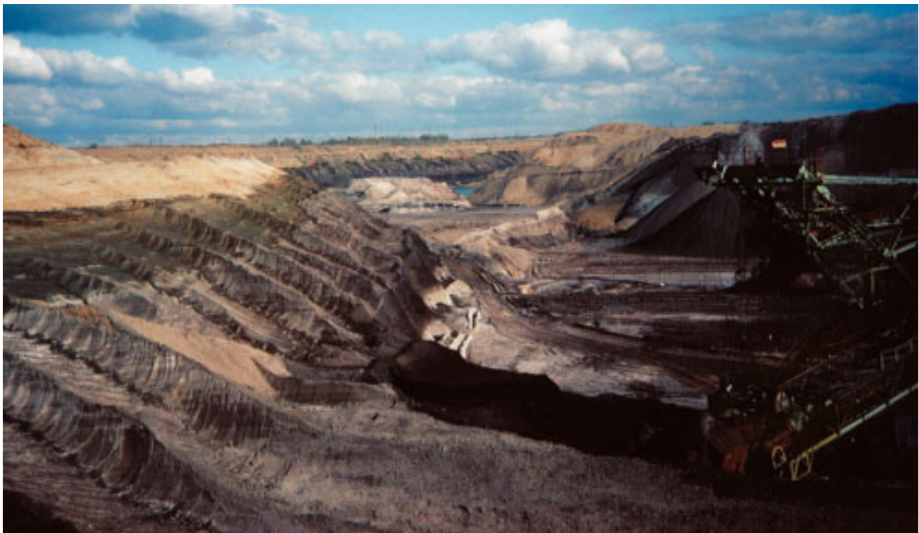
Abb. 2-1-7: Tagebau Zwenkau bei Knautnaundorf (1990) als Beispiel der Lagerungsverhältnisse auf der Nordwestsächsischen Hochscholle. Weiß im Mittelgrund ein kaolisierter Berg aus Leipziger Grauwacke („Tonberg“). Darüber und im Vordergrund neben dem Schaufelrad das Böhlener Oberflöz, im Mittelgrund links der Kippe das Bornaer Hauptflöz. Über dem Böhlener Oberflöz die mächtigen unterliogozänen Meeressedimente, unten (hellgrau) der Braune Sand und Schluff, darüber (grau bis dunkelgrau) der Glaukonitschluff und einige Meter Grauer Sand. Oben das Quartär aus frühelstereiszeitlichen Schottern von Saale und Weißer Elster, Elstergrundmoräne, frühsaaleeiszeitlichen Schottern der Weißen Elster und Saalegrundmoräne sowie weichseleiszeitlichem Sandlöß (Foto: EISSMANN)
