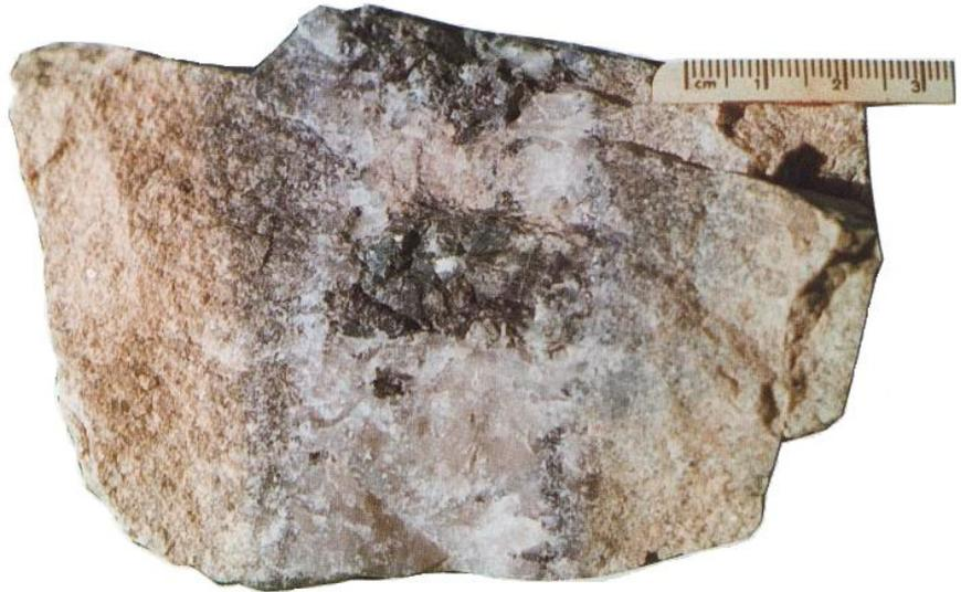
Abb. 75: Greisen mit viel Kassiterit und Gilbertit; 150 m-Sohle, Hauptquerschlag Nord bei 18 m, Weststoß.
