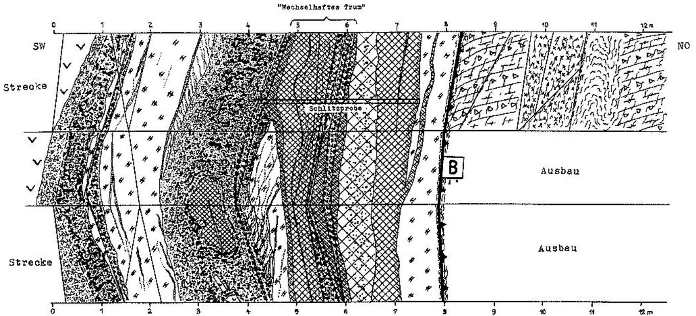
Abb. 39: Flußspatgrube Schönbrunn, Beispiel zur Aufschlußdokumentation, 93 m-Sohle, Querschlag 45 NO, Firste, NW- und SO-Stoß. Legende wie in Abb. 36
