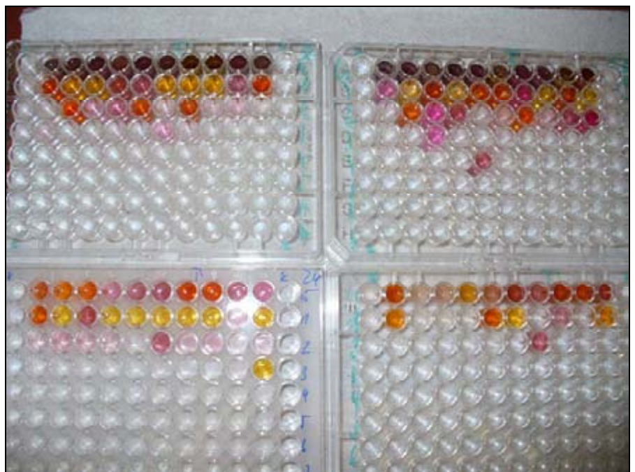
Abb. 12: Nachweis von Thiobacillus denitrificans auf Mikrotiterplatten (MPN-Methode)
