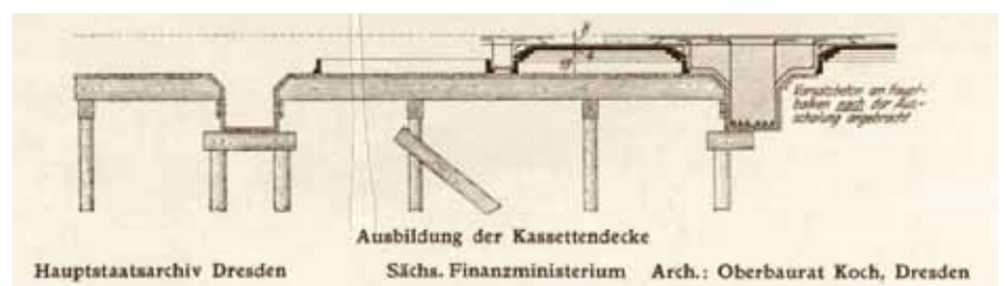
Konstruktive Ausbildung der Kassettendecke, Baustellenfoto und zeitgenössische Detailzeichnung
