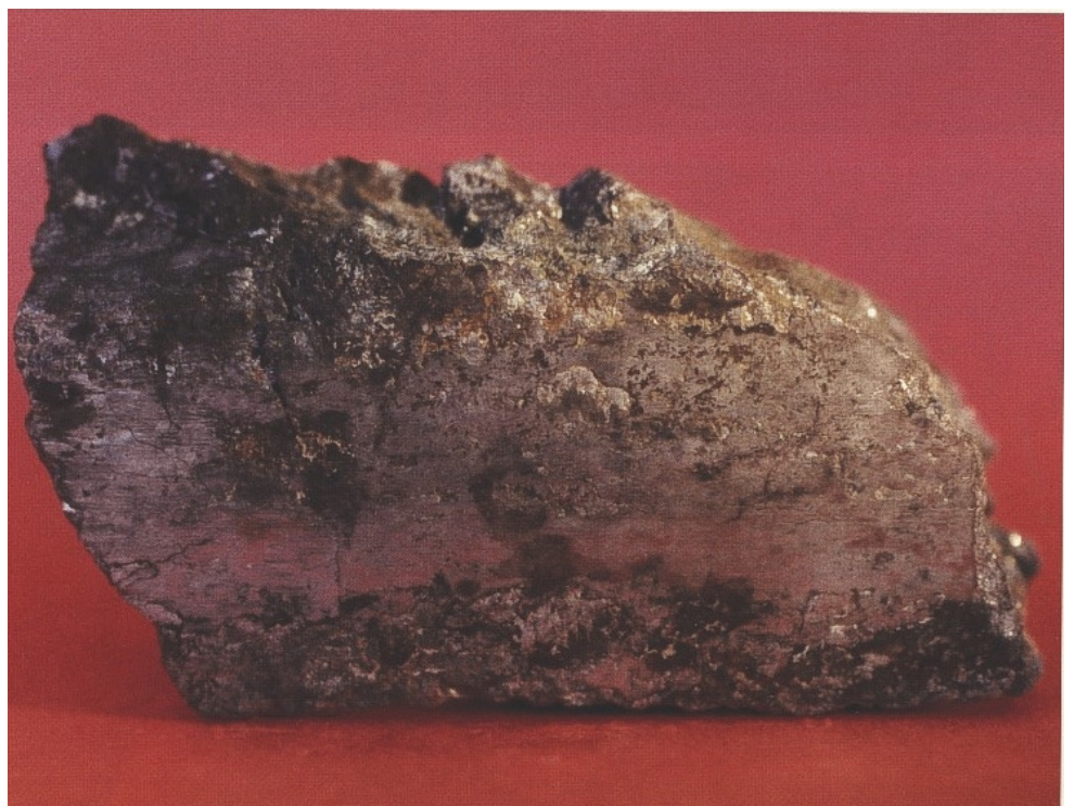
Abb. 23: Harnischbildung auf Co-Ni- Arseniden. Schacht 366, Sohle -390m, Strecke 2719, Gang „Alber- ode II“. Foto und Sammlung: FLACH
