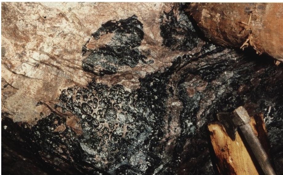
Abb. 25a: Gelförmige und lagige Textur von Pechblende in Dolomit mit Clausthalit in einem Gang der mgu-Formation, dse-Abfolge. Schacht 371, Sohle -1530 m, Zentralfeld, Abbaublock 0336, Bereich Störung „Erna II Ost liegend“ Foto: W. Schreiber, Neu-Isenburg, Original in 3D-Flaumbildtechnik
