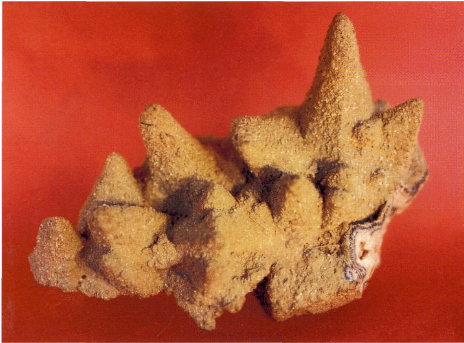
Abb. 30: Imprägnationstextur in einem Gang der Quarz-Scheelit-Abfolge (Die Originale der nachfolgenden Abb. 31 und 32 sind nicht mehr erhalten. Es folgt deshalb Abb. Nr. 33)
