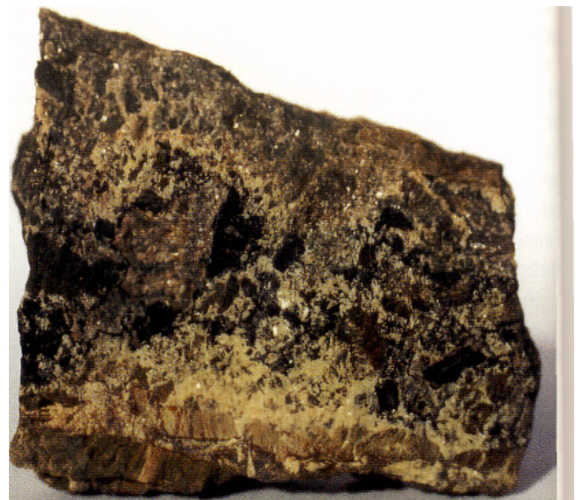
Abb. 40 Mechanische Umlagerung von Pechblende als Brekzien, eingebettet in Dolomit. mgu-Formation. Schacht 38. Foto und Sammlung: FLACH
