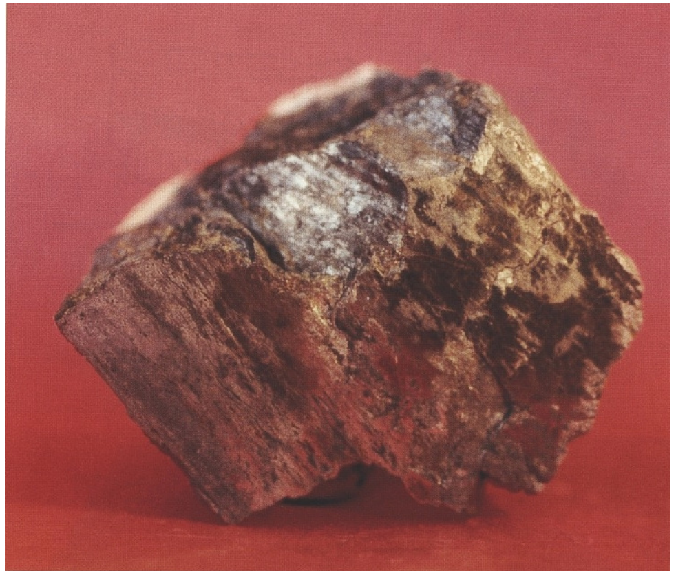
Abb. 22: Harnischbildung auf Co-Ni- Arseniden der eba-Abfolge. Schacht 250, Sohle -330 m, Strecke 124, 6,0 m östlich vom Durchschuss in Strecke 725, Gang „Schwerin II“ Foto und Sammlung: FLACH
