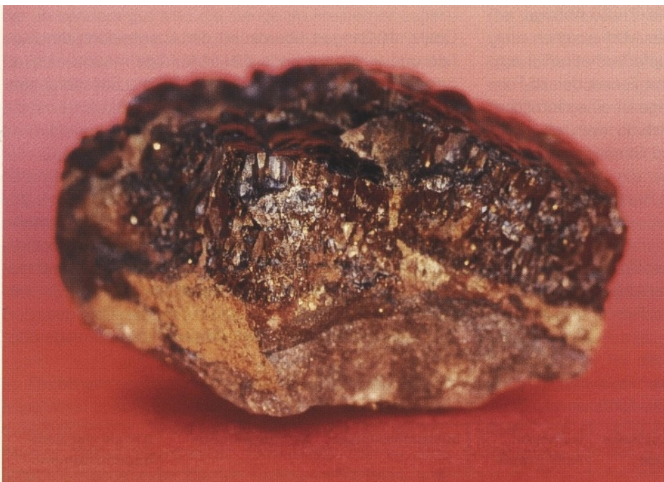
Abb. 37: Pechblende auf Galenit, Sphalerit und Pyrit; kb-kku-Formation. Schacht 38 Foto und Sammlung: FLACH
