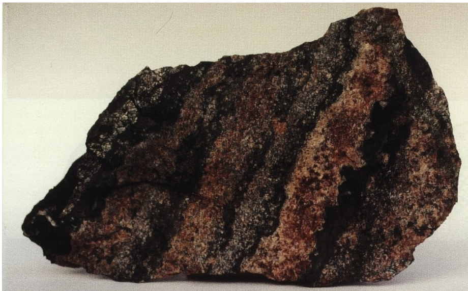
Abb. 25: Lagige Textur von Pech- blende und Dolomit mit Clausthalit in einem Gang der mgu-Formation, dse-Abfolge. Schacht 371, Sohle -1530 m, Zentralfeld, Abbaublock 0336, Bereich Störung „Erna II Ost liegend“ Foto und Sammlung: FLACH
