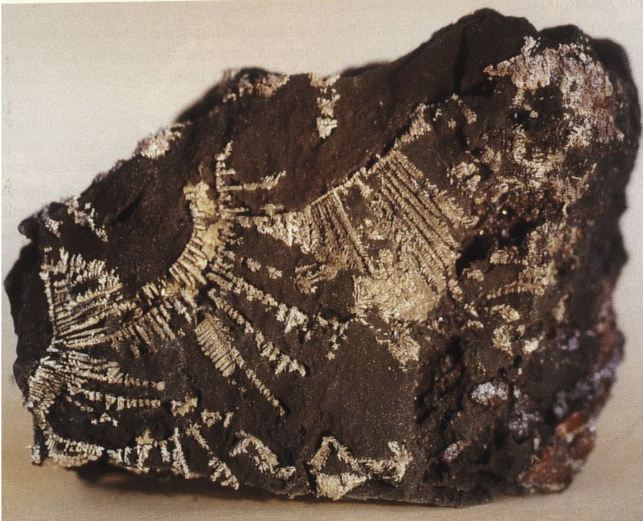
Abb. 64: Gediegen Silber und Kristallnegative nach gediegen Silber mit Proustit in gediegen Arsen. Schacht 366, Sohle -720 m, Gang „Nelson“, Bereich Störung „Union Liegend.“
