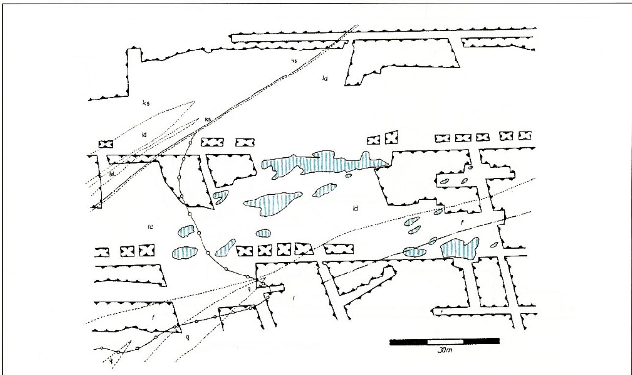
Abb. 202: Co-Ni-Arsenid-Vererzung der eba-Abfolge ist im Liegenden einer Scharung von zwei Gängen dritter Ordnung an den Grenzbereich von Metabasiten und Phylliten (Fruchtschiefer) ausgebildet. Gang „Neiwa“, Sohle -270/-240/-210 m (NW-Anschluss zu Abb. 199)
