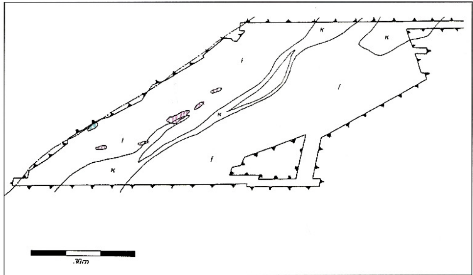
Abb. 209: Gediegen Silber der arsenidisch-quarzigen Abfolge tritt unmittelbar im Liegenden einer streichenden Störung in Assoziation mit Co-Ni-Arseniden auf und ist im Bereich von Kersantit I mit gediegen Arsen vergesellschaftet. Gang „Rio Tinto“, Sohle -675 m
