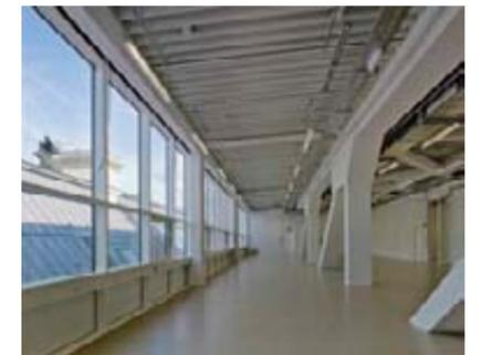
Für die Restaurierung der Gemälde sind vor allem die nach Norden ausgerichteten Werkstattbereiche vorgesehen. Im Innenraum wurde auf möglichst neutrale Farben geachtet, um Verfärbungen auf den Gemälden zu vermeiden. Auf der Südseite wurde eine Sonnenschutzvorrichtung eingebaut, die die äußeren Einflüsse neutralisieren kann.
