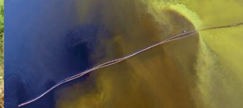
neutralizace jezera Scheibe Sees řízenou distribucí suspenze vápenného mléka
