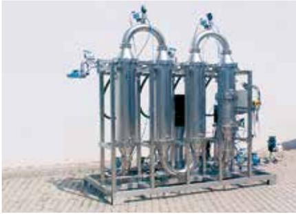
Nanofiltrations-Membrananlage zur Diafiltration
