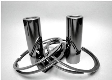
Kolbenbolzen und Kolbenringe beschichtet mit diamantähnlichem Kohlenstoff
