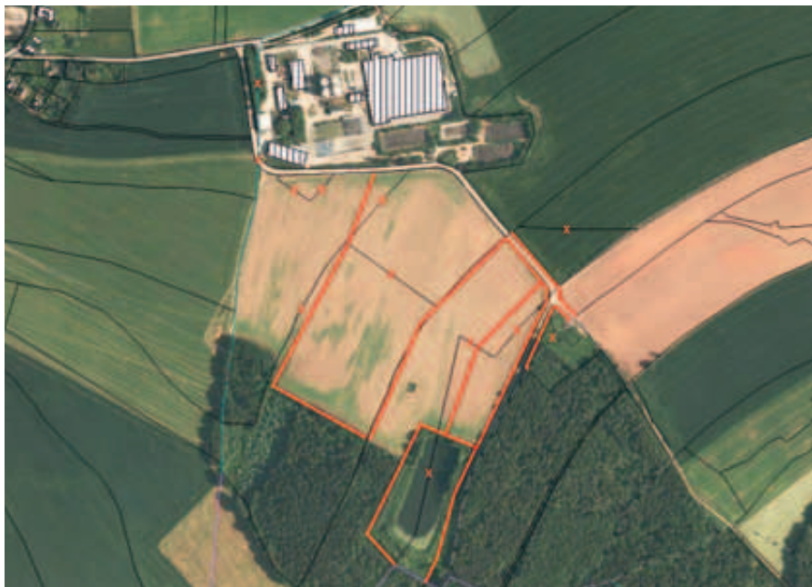
Das Betriebsgelände der Agrargenossenschaft »MAVEK« eG und genannter Abwasserteich aus der Vogelperspektive mit zugehörigem Ausschnitt aus der Katasterkarte. In Rot sind die neu verhandelten Grenzen dargestellt, wegfallende Flurstücksgrenzen gekreuzt; Quelle: GeoSN, Landratsamt Erzgebirgskreis
