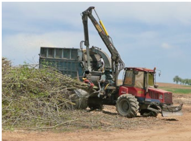
Abbildung 33: Selbstfahrender Hacker zur Erzeugung von Hackschnitzeln aus Kronenmaterial
