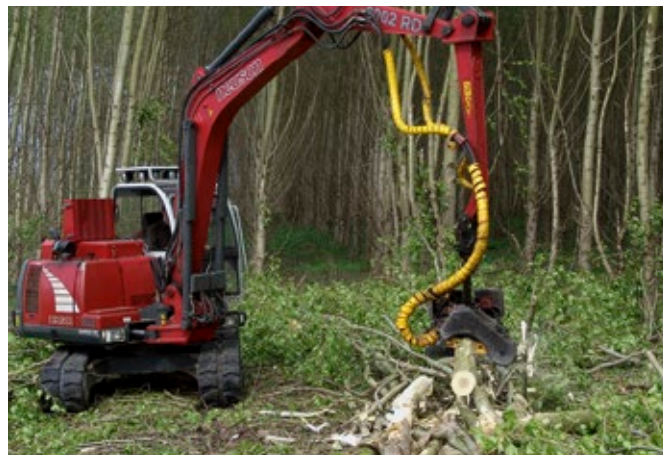
Abbildung 29: Kleinbagger mit Harvesterkopf in 13-jähriger Pappel
