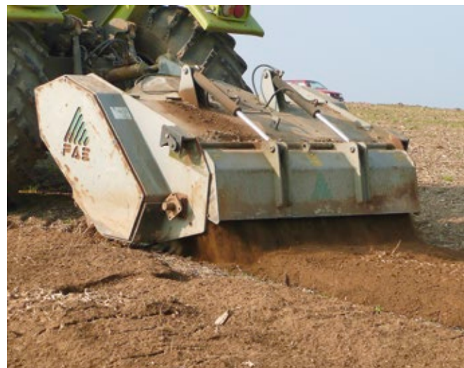
Abbildung 52: Rodefräse (URF 200 FAE) mit einer Arbeitsbreite von 200 cm
