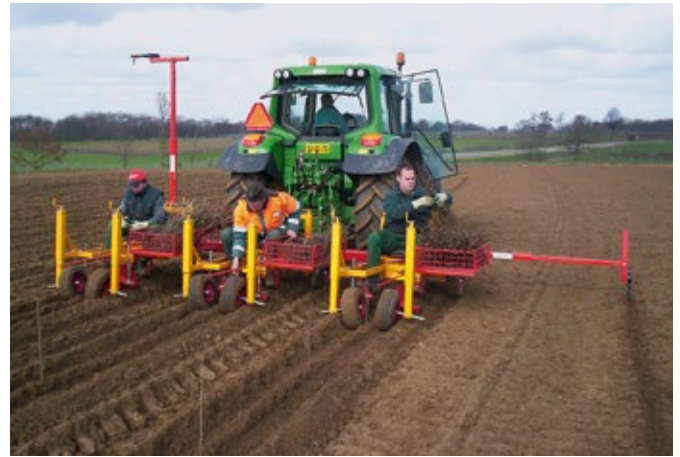
Abbildung 8: Pflanzmaschinen PL-10/3 zum Einbringen von wurzelackten Pflanzen
