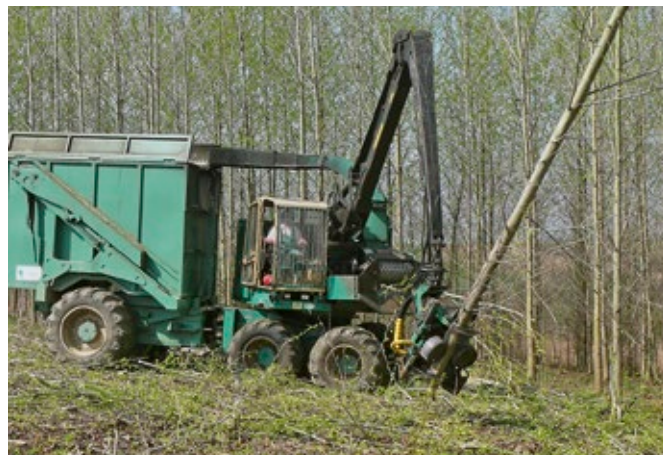
Abbildung 31: Prototyp Hackschnitzelharvester in 10-jährigem Pappelbestand
