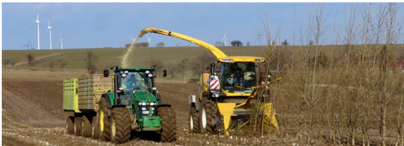
Abbildung 32: Selbstfahrender Häcksler New Holland mit Holzerntevorsatz
