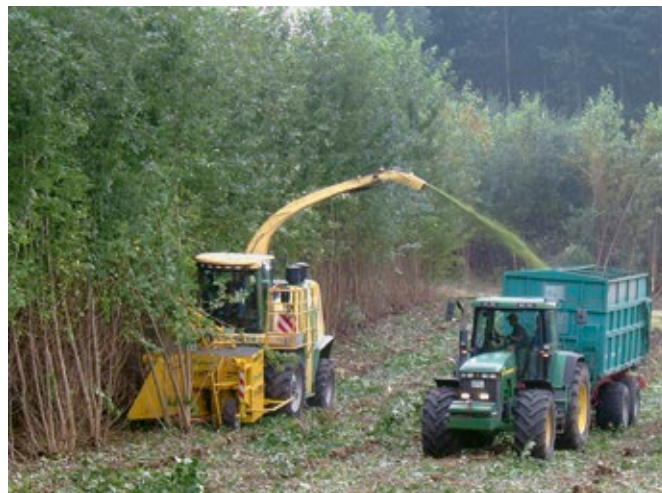
Abbildung 34: Selbstfahrender Häcksler Krone/Hüttmann mit Holzerntevorsatz
