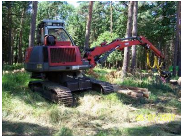
Abbildungen 36 und 37 Einsatz von Maschinen mit biologisch abbaubaren Betriebsstoffen im Forstbetrieb Friebe
