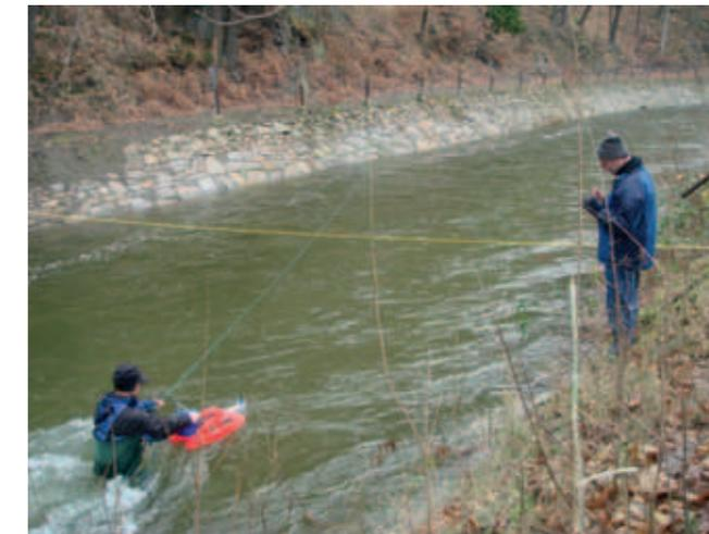
Durchflussmessung mit einem Ultraschallgerät und einem Messboot
