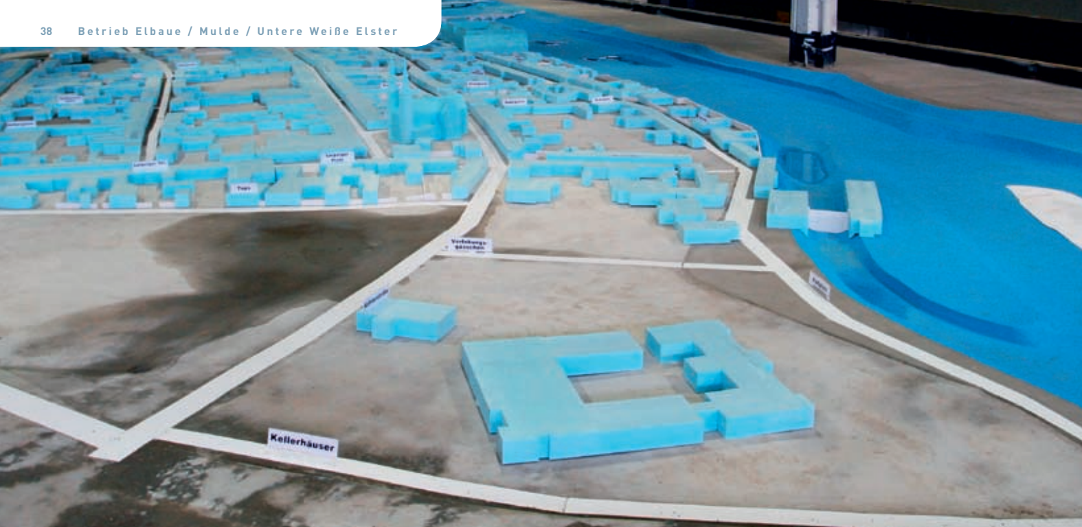
Physikalisches Modell im Maßstab 1:50 der Vereinigten Mulde und der Innenstadt von Grimma
