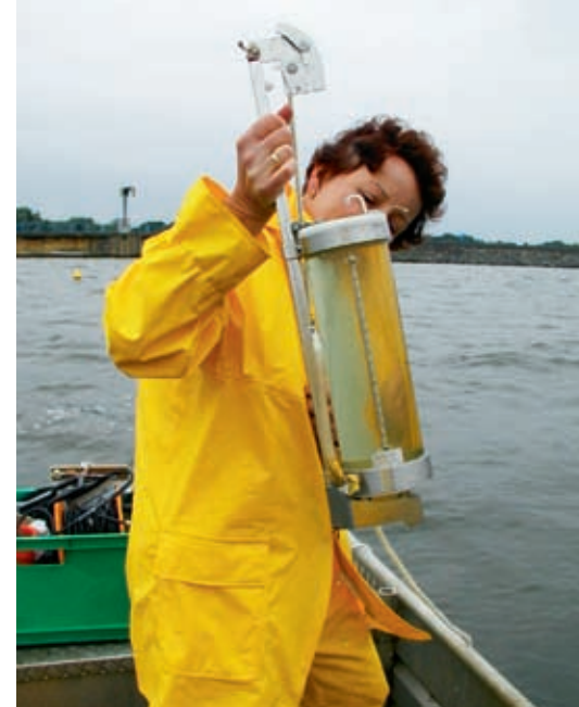
Probenahme aus dem Tiefenbereich einer Talsperre mit einem Wasser-Schöpfer
