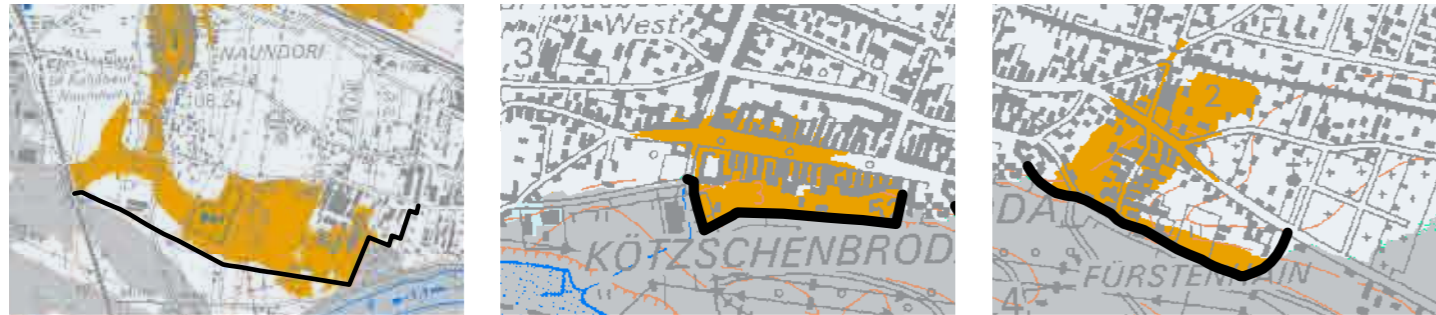
Kartenansichten der Hochwasserschutzlinien Naundorf, Altkötzschenbroda und Fürstenhain mit den eingezeichneten Überschwemmungsflächen (gelbe Fläche) im IST-Zustand (Quelle: © LTV, Karten: GeoSN)
