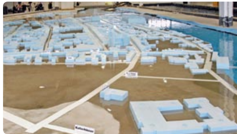
Physikalisches Modell Maßstab 1:50 der Vereinigten Mulde und der Innenstadt von Grimma
