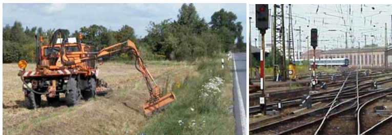
Kommunaltechnik und Weichenschmierung - Einsatzgebiete für biologisch schnell abbaubare Hydrauliköle und Schmierstoffe
