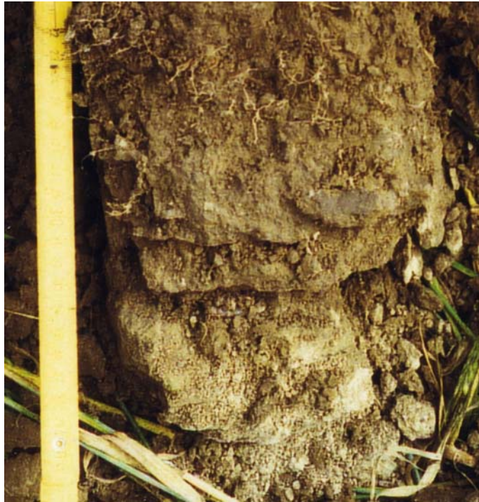
Ungünstig: Plattiges Gefüge unterhalb der Pflugsohle
