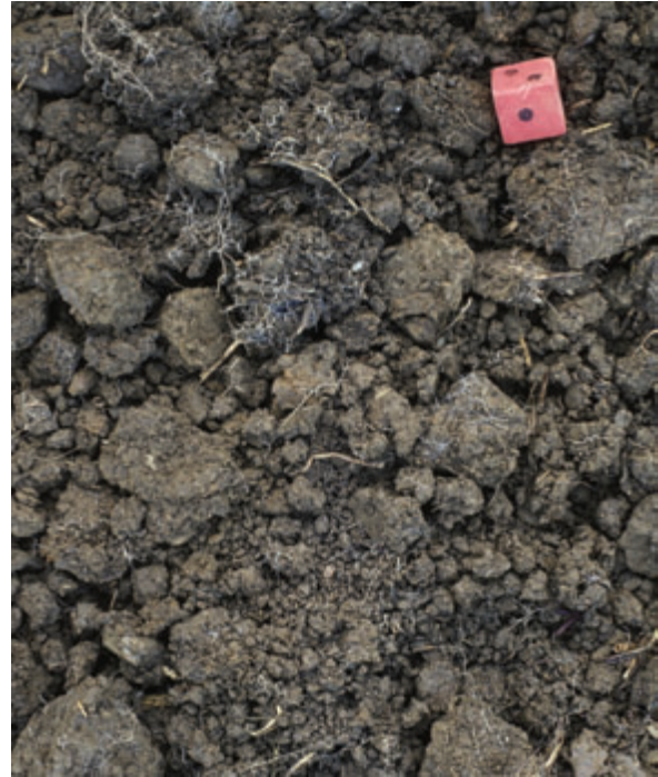
Abb. 34: Mischgefüge aus etwa 50% Krümeln und 50% Bröckeln (Gefügenote 1,5)
