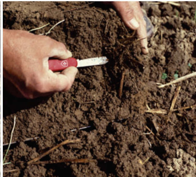
Abb. 12: Vorsichtiges Zerlegen des Bodenblocks mit den Händen oder einem Taschenmesser
