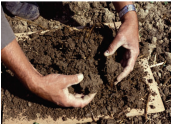
Abb. 14: Beim behutsamen Zerteilen werden Gefügeform, Farbe und Wurzelbild registriert
