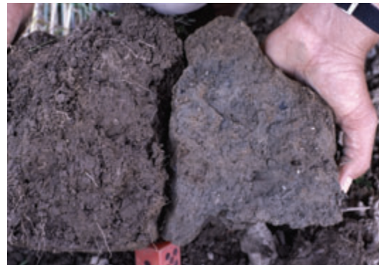
Abb. 48: Links: Bodenprobe außerhalb der Spur. Rechts: Bodenprobe in der Spur (graublau verfärbt)
