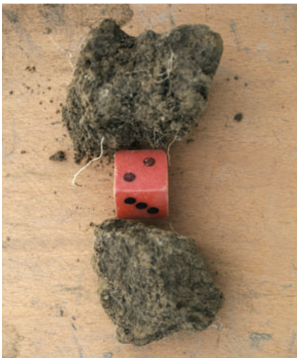
Abb. 35: Je nach Porosität und Festigkeit erhalten Bröckel die Gefügenote 2 oder 3; oben: lockerer, poröser Bröckel (2) unten: dichter, fester Bröckel (3)
