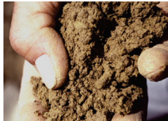
Abb. 15: Durch Zerdrücken mit der Hand werden Festigkeit und Zerfall der größeren Aggregate geprüft
