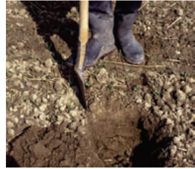
Abb. 10: Der auszuhebende Bodenblock wird durch seitliches Einstechen abgegrenzt
