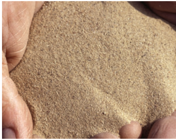
Abb. 28: Einzelkorngefüge. Die Mineralkörner liegen lose nebeneinander, geringes Wasserhaltevermögen (Gefügestrukturnote 3)
