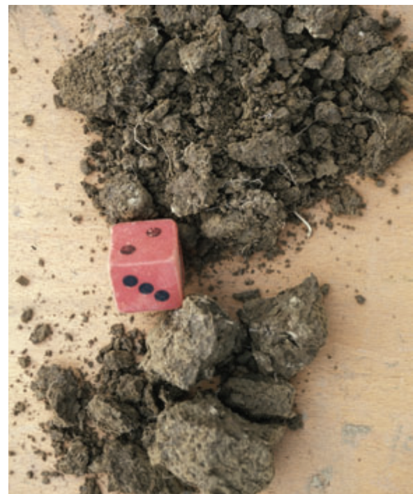
Abb. 36: Zerfall der abgebildeten Bröckel bei Druck (der rote Würfel hat eine Kantenlänge von 3 cm)
