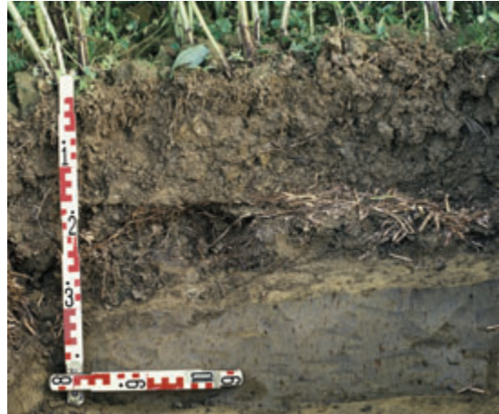
Abb. 50: „Strohmatratzen“ werden von den Wurzeln gemieden und behindern die Wasserbewegung
