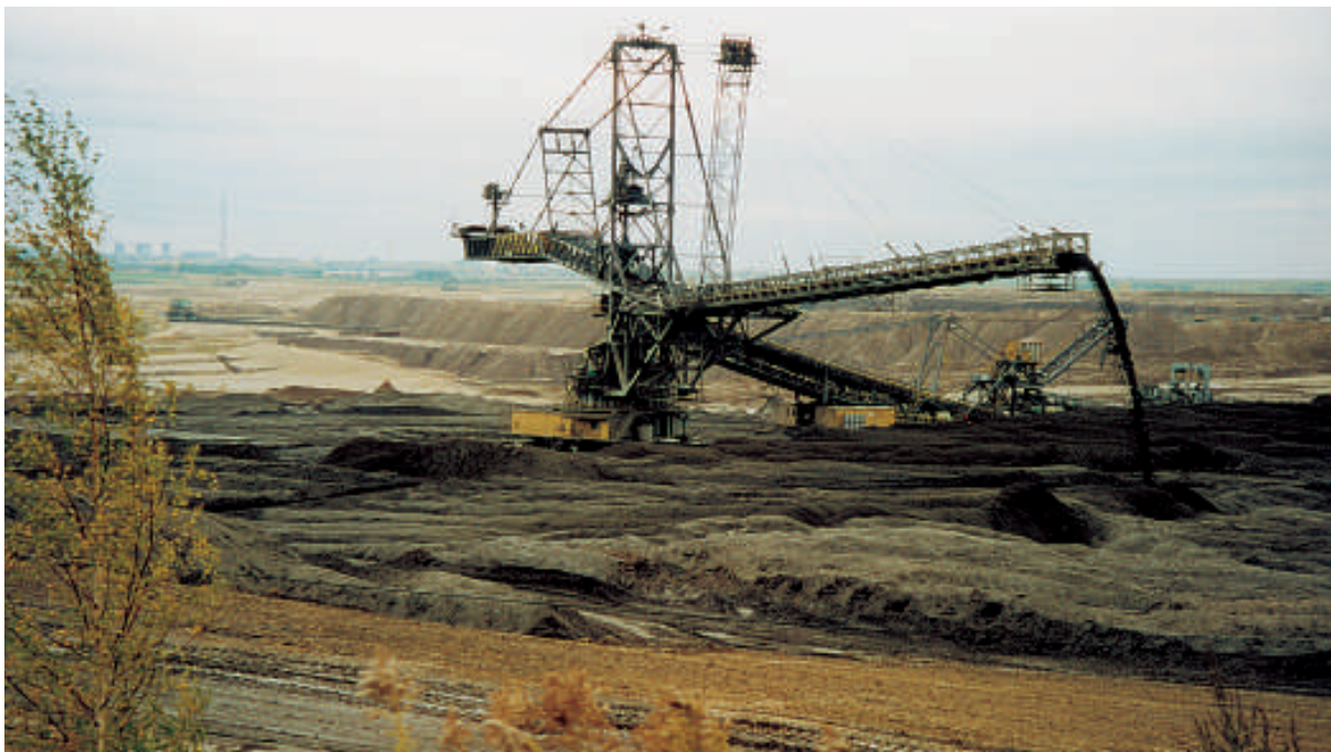
Abbildung 11: Förderbrücke beim Verfüllen des Restloches des Tagebaus Espenhain
