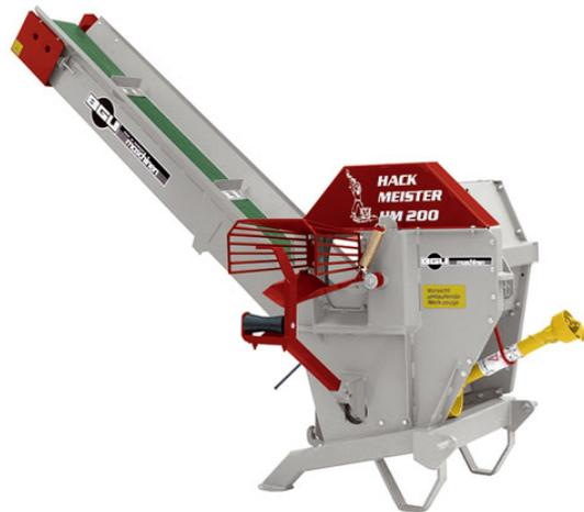
Der Hackmeister ist eine kombinierte Maschine, mit der vorgespaltenes Holz sowie auch Rundhölzer sämtlicher Holzarten bis 200 mm Durchmesser in einer Phase gespalten und abgeschnitten werden können.
