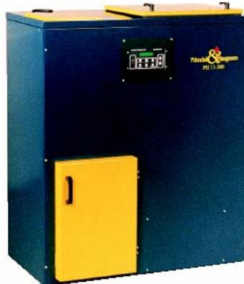
Mittels Förder- / Austragungsschnecke wird aus einem Vorratsraum Brenngut in den Brennstoffvorlagenbehälter der Anlage gefördert. Diese ist selbstverständlich mit einer Rückbrandsicherung versehen. Unter dem Brennstoffvorlagenbehälter, der mit einer Niveauekontrolle als Mangelsicherung ausgerüstet ist, fördert eine Schnecke das Brenngut in den Multibrenner.
