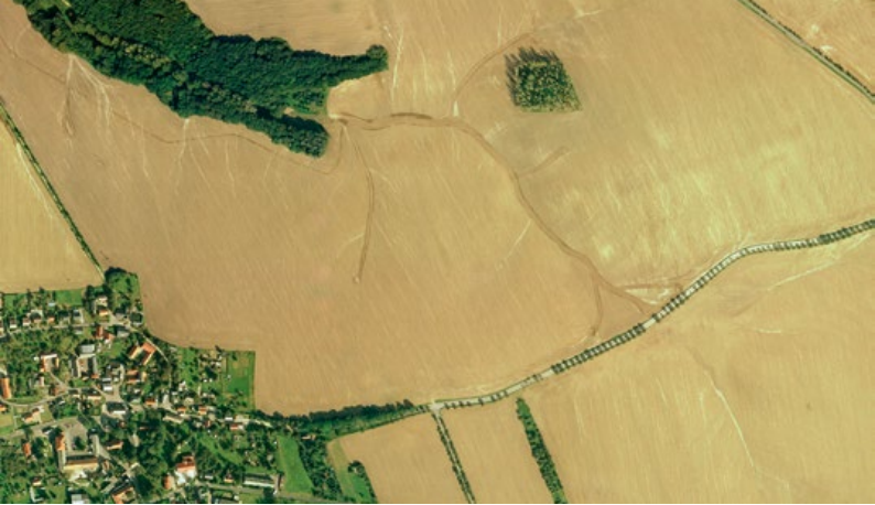
Luftbild von 2002 mit wiederholt erheblichen Erosionsschäden entlang der ackerbaulich genutzten Abflussbahn
