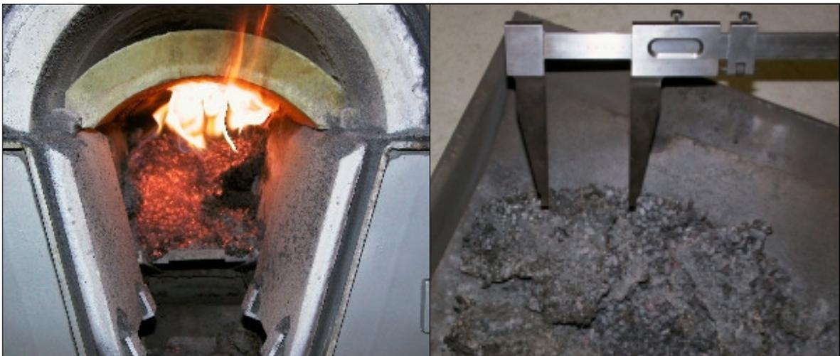
**Abb. 3/21:** links: aufgehäuften Verbrennungsaschen; rechts: Schlackebrocken (ILK)
