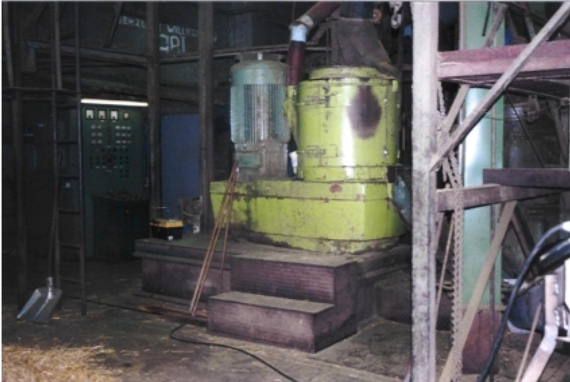
**Abb. 3/5:** Kollergang-Press (rechts) mit Elektromotor (mitte) und Schaltzentrale (links); Landwirtschaftliche Trocknungs- und Dienstleistungs GmbH Grimma
