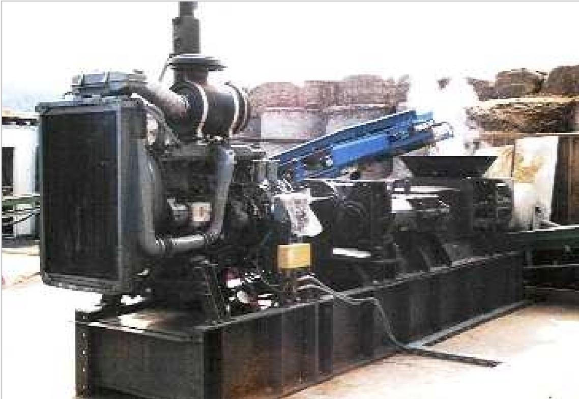
**Abb. 3/4:** Doppelschneckenextruder der Fa. Lehmann Maschinenbau GmbH in Jocketa
