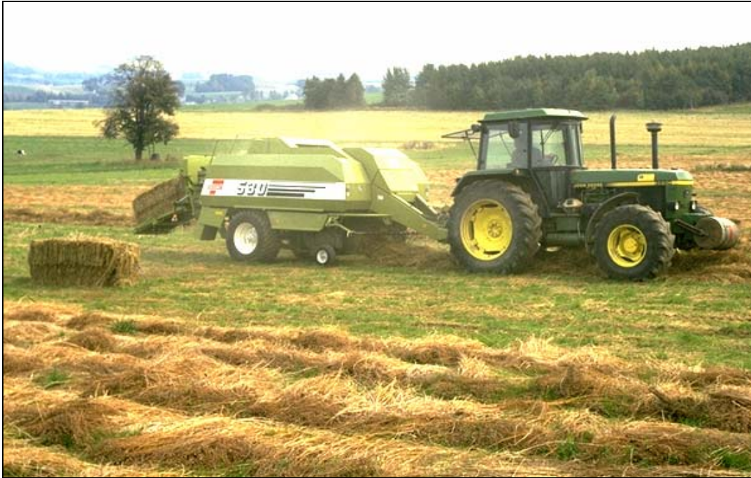
Abbildung 14: traktorgezogene Quaderballenpresse beim Pressen von Flachswirrstroh Zur Bergung des gerösteten, geschwadeten Flachswirrstrohes finden in den Landwirtschaftsbetrieben leistungsfähige Strohpressen, vor allem Quaderballenpressen (Abbildung 14) Verwendung.
