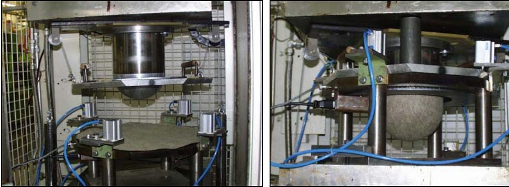
Bild 20: Tiefzieh- Versuchsanordnung im KVB Chemnitz mit eingelegtem Hanf – Polypropylen - Vlies (rechts) und während des Tiefziehvorganges (links)
