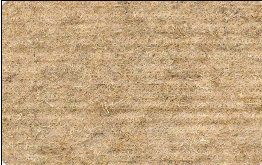
Bild 19: Vlies aus 70 % Hanffasern (Pilotanlage / Ballenauflöser) und 30 % PP – Fasern, Flächengewicht 332 g/m<sup>2</sup>, (lfd. Nr. 5)
