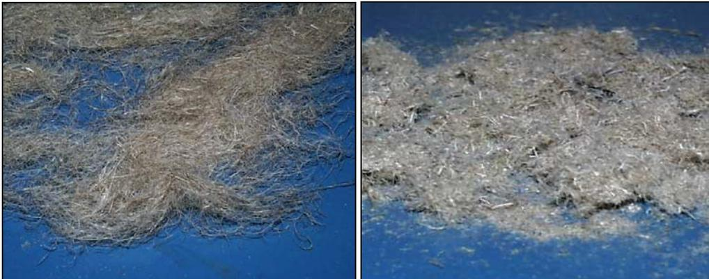
Bild 31: Hanffasern vor dem Zerkleinern (links) und nach dem Zerkleinern mit der Laborschneidmühle
