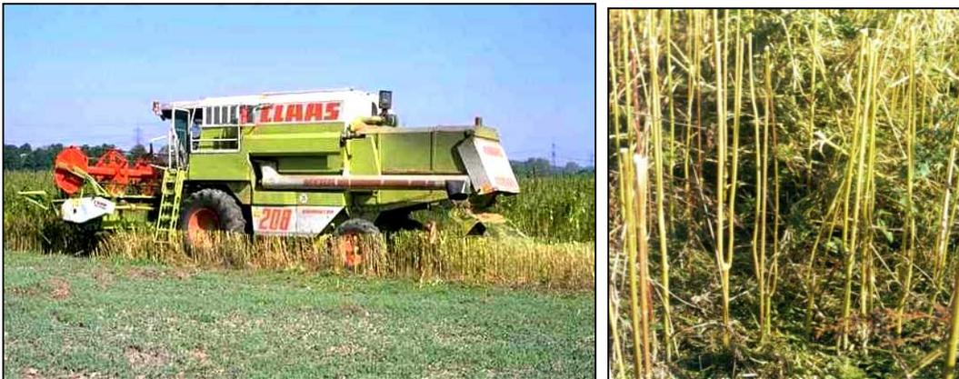
Bild 4: Mähdrusch von bei 40 cm (Wuchshöhe ca. 50 cm) geköpften Hanf, (links) und Reststängel nach dem Mähdrusch, (rechts), Praxisversuch Adorf 1999
