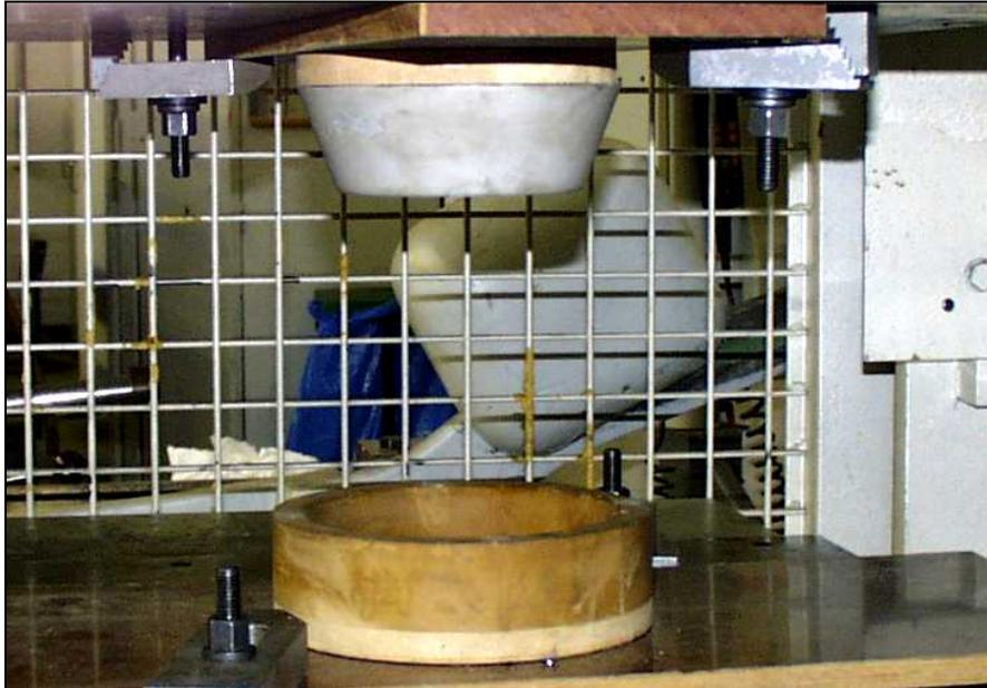
Bild 27: Umformwerkzeug für die Herstellung von Formpressteilen
