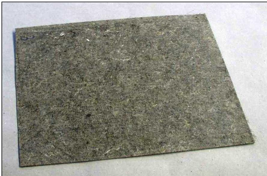
Bild 22: Pressplatte aus 70 % Hanffaser (Pilotanlage / Dosierer) und 30 % Polypropylenfaser (erste Versuchsreihe, Versuchsnummer 5)
