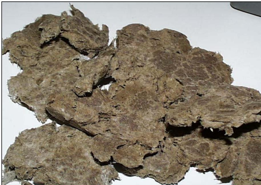
Bild 34: Mischung aus 60 % Hanffasern und 40 % PP nach Verlassen des Mixers und Auswalzen
