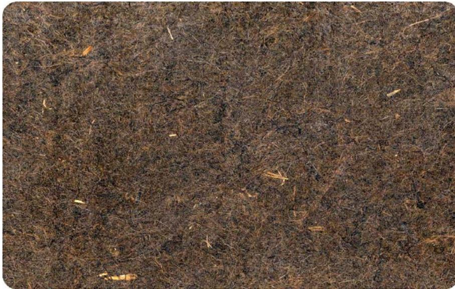
Bild 23: Platte aus 60 % Hanffasern (Pilotanlage / Dosierer), 40 % PP-Fasern (Vlies Ifd. Nr.2)
