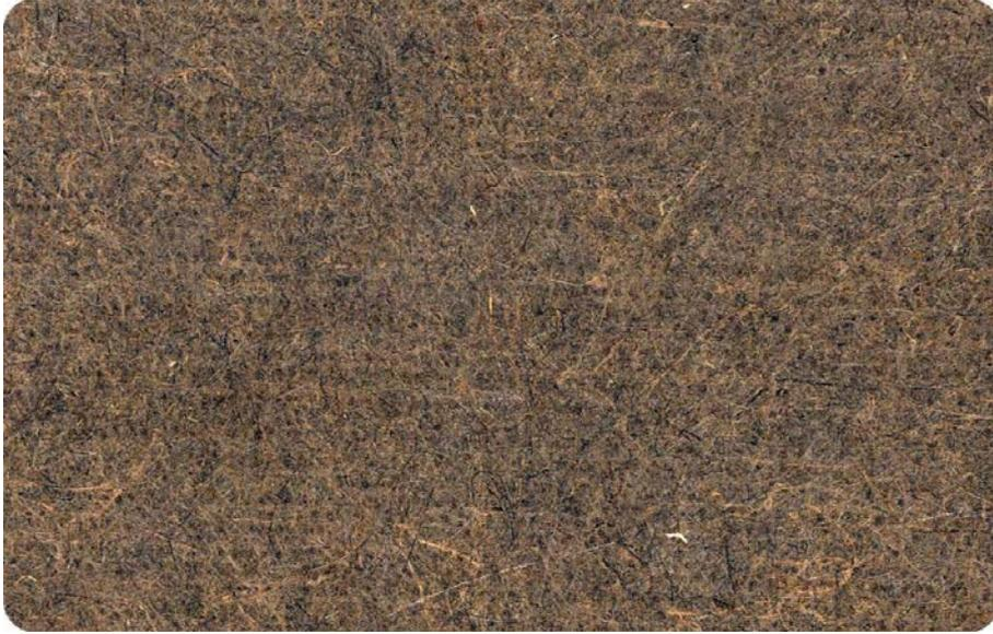
Bild 24: Platte aus 70 % Hanffasern (Pilotanlage / Dosierer), 30 % PP-Fasern (Vlies lfd. Nr. 4)
