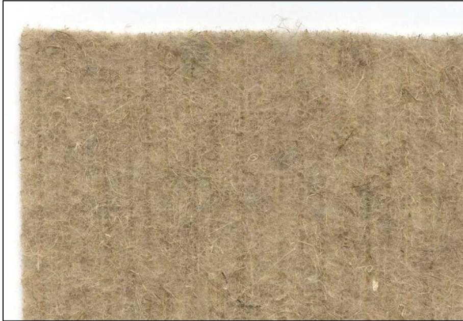
Bild 16: Vlies aus Mischfaser 80 % Hanffasern (Pilotanlage / Ballenauflöser) und 20 % Polypropylenfasern, ohne Träger
