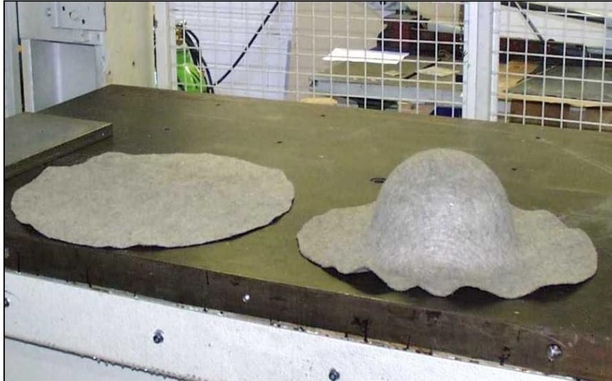
Bild 21: Vlies (Ifd. Nr. 4) aus 70 % Hanffasern (Pilotanlage / Dosierer) und 30 % Polypropylenfasern, (links) und daraus hergestelltes Tiefziehteil (rechts)
