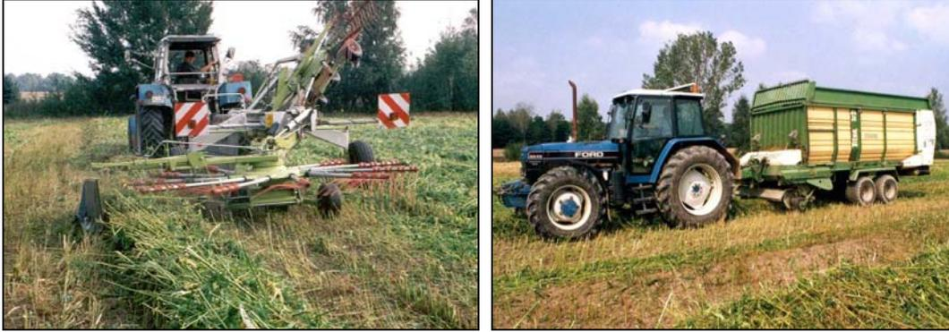
Bild 45: Schwaden (links) und Bergung mit dem Ladewagen (rechts) von angewelktem Hanfgrünstroh für die Silierung
