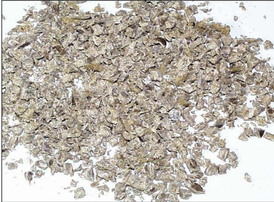
Bild 35: Granulat aus Hanffaserstoff und Polypropylen
