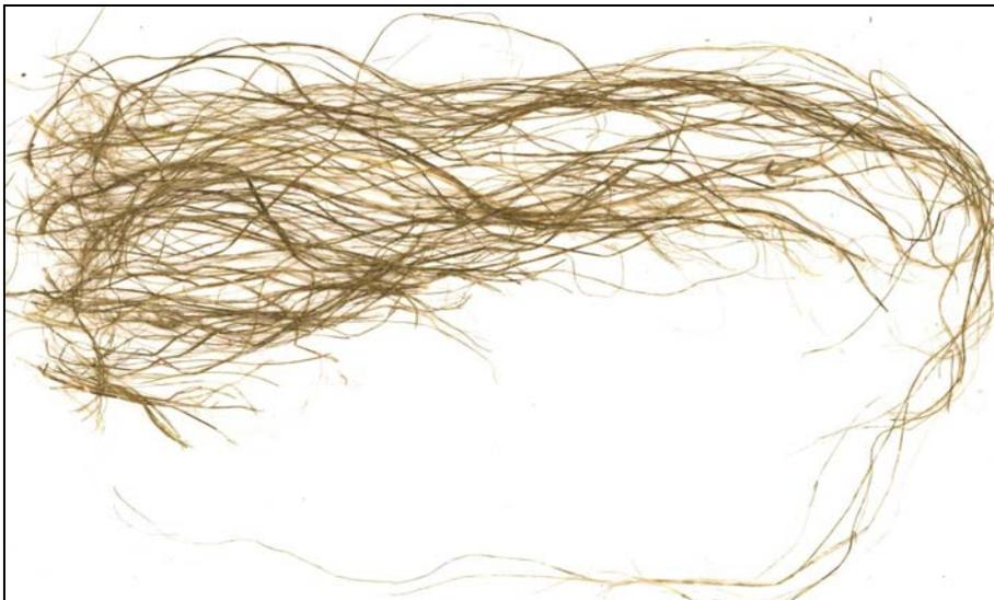
Bild 10: Stapeldiagramm von Hanffasern der Pilotanlage Lehmann Maschinenbau GmbH Jocketa, Variante „Dosierer“, Ausgangsmaterial: loses Hanfröststroh aus Ladewagentechnologie und Mietenlagerung
