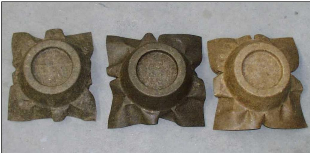
Bild 28: Formpressteil-Rohlinge, hergestellt aus Hanf-PP-Vliesen unterschiedlicher Zusammensetzung
