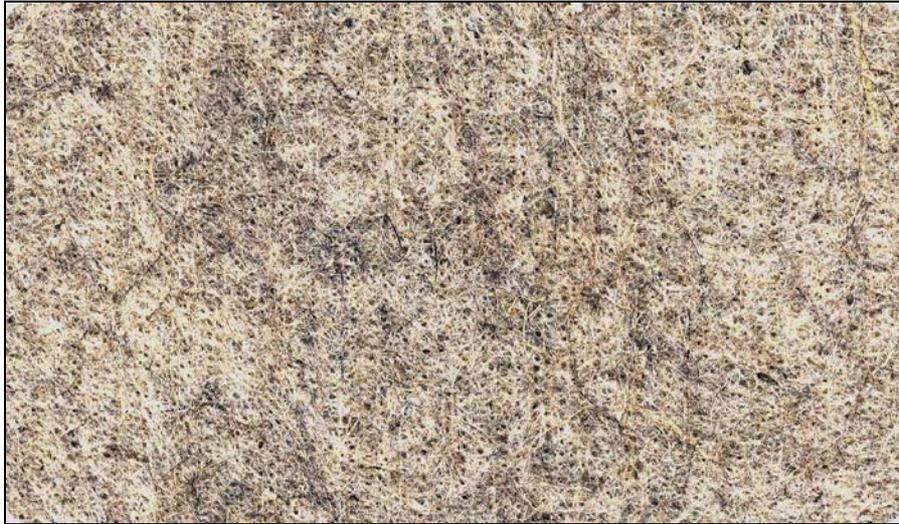
Bild 17: Vlies aus 60 % Hanffasern (Pilotanlage / Dosierer) und 40 % PP – Fasern, Flächengewicht 515,5 g/m<sup>2</sup>, (Ifd. Nr. 2)
