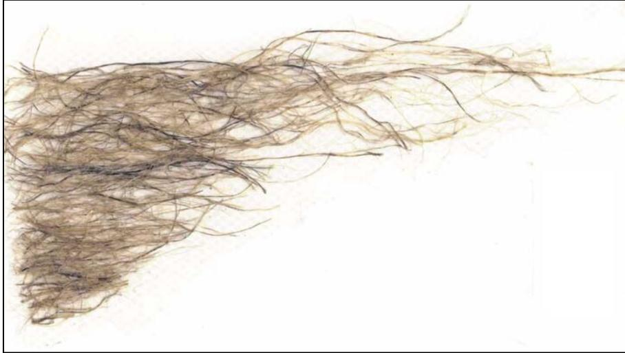
Bild 9: Stapeldiagramm von Hanffasern der Pilotanlage Lehmann Maschinenbau GmbH Jocketa, Variante „Ballenauflöser“, Ausgangsmaterial: Hanfröststroh aus Pressgutlinie und Lagerung unter Dach
