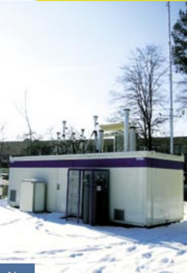
Das neue Messgerät misst die Verteilung der Luftpartikelgrößen von Ultrafeinstaub an vier Stellen in drei Ländern:
