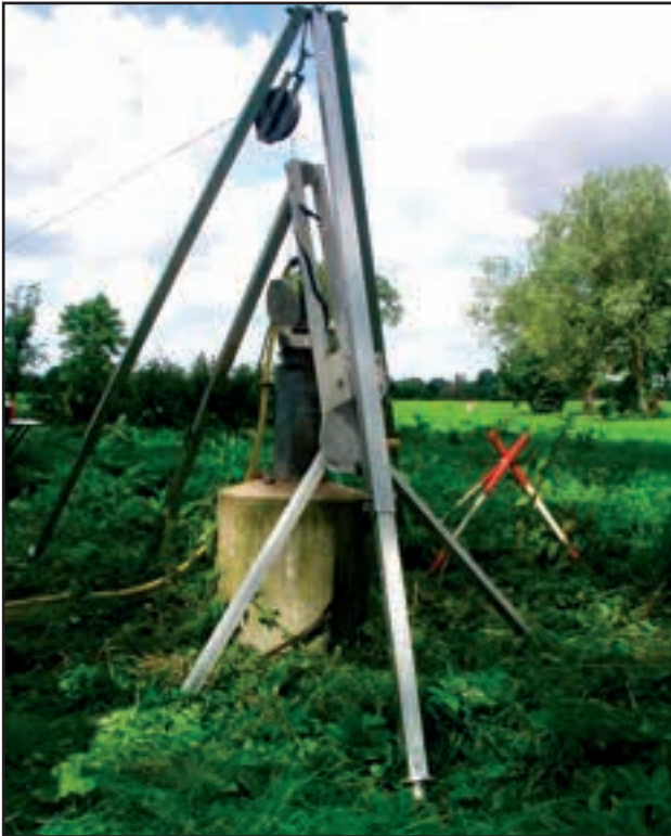
Bohrlochgeophysikalische Messungen während der Beprobung einer Grundwassermessstelle (Foto: LfUG)
