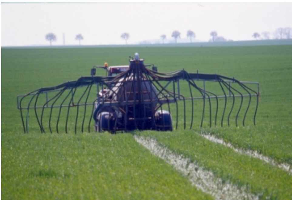
Abbildung 15: Ausbringung von Gülle in Weizen mit Schleppschlauchverteiler
