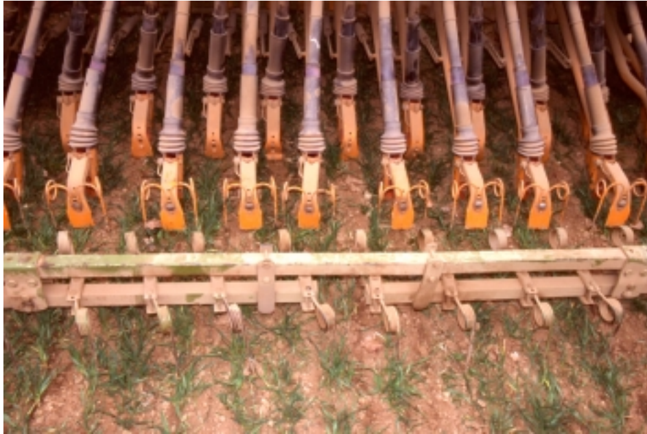
Abbildung 16: Aussaat einer Klee gras-Untersaat in einen Winterweizenbestand im Frühjahr mit der Drillmaschine
