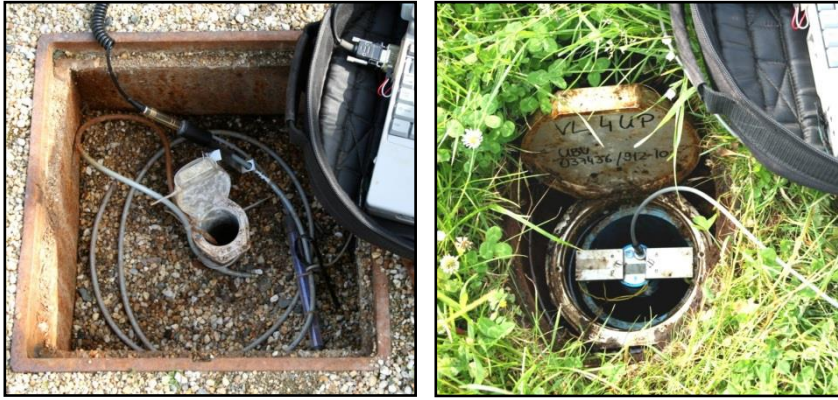
Abbildung 7: Grundwasserpegel im Kurpark von Bad Brambach mit Drucksonden
