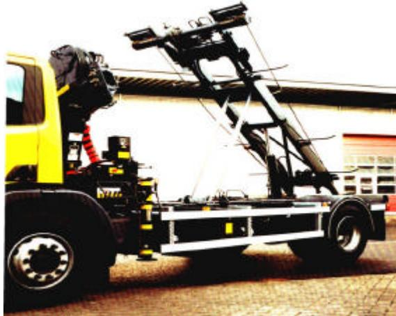
**Abb. 2 LKW mit Seilgeräteaufbau für Abgleitkipper**
