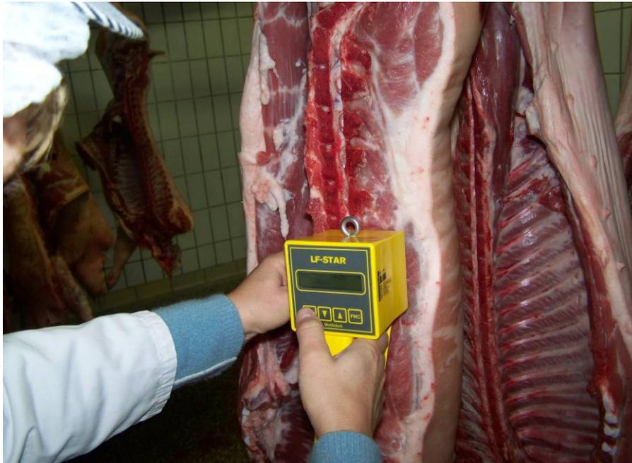
**Abbildung 17: Messung der Leitfähigkeit**
