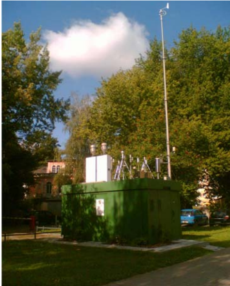
Abbildung 34: Nahaufnahme von der Messstation Dresden Winkelmannstraße mit Aufbauten der PM 2,5 - Vergleichsmessung
