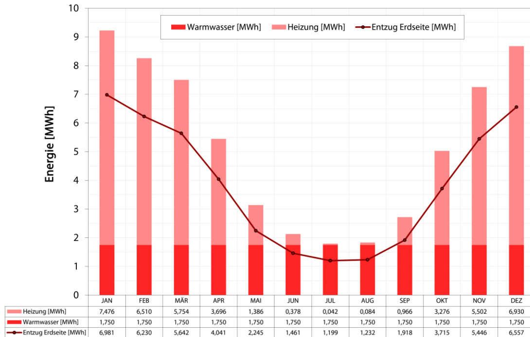
Abbildung 43: Fiktive Anlage MFH (30 kW) – Monatliche Lastverteilung
