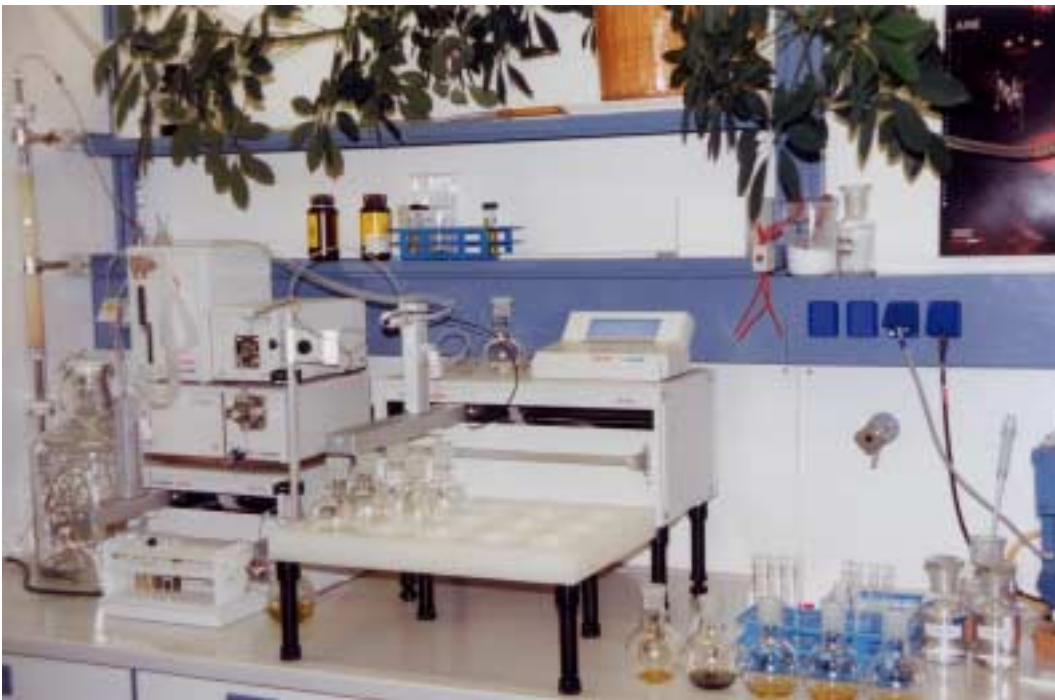
Probenvorbereitung von Pflanzenextrakten mittels GPC
