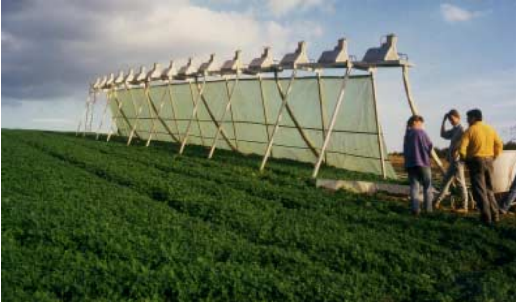
Messung zur Minderung des Bodenabtrags mit einer Beregnungsanlage
