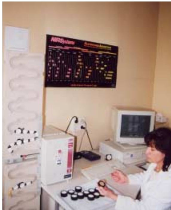
Qualitätsuntersuchungen von Futtermitteln und Pflanzen mit Hilfe der Nah-Infrarot-Reflektions-Spektroskopie (NIRS)
