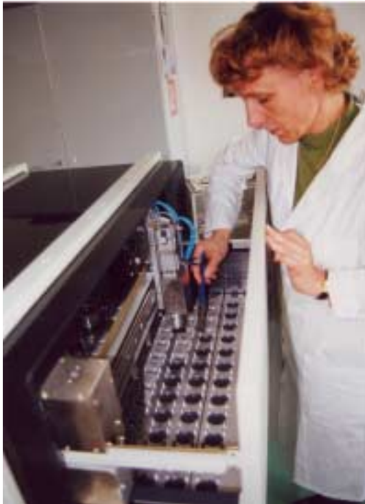
Mineralstoffbestimmung in Futtermitteln und Pflanzen mittels Röntgenfluoreszenzanalyse
