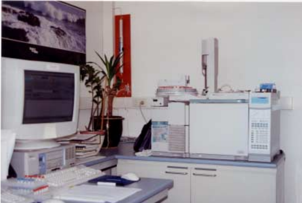
Moderne Gerätetechnik für die organische Rückstandsanalytik: GC-MS-Kopplung
