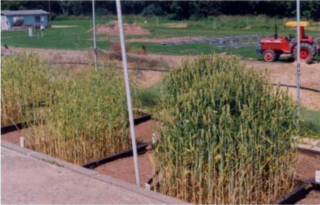
Lysimeteranlage – Weizen bei unterschiedlicher Gülldüngung
