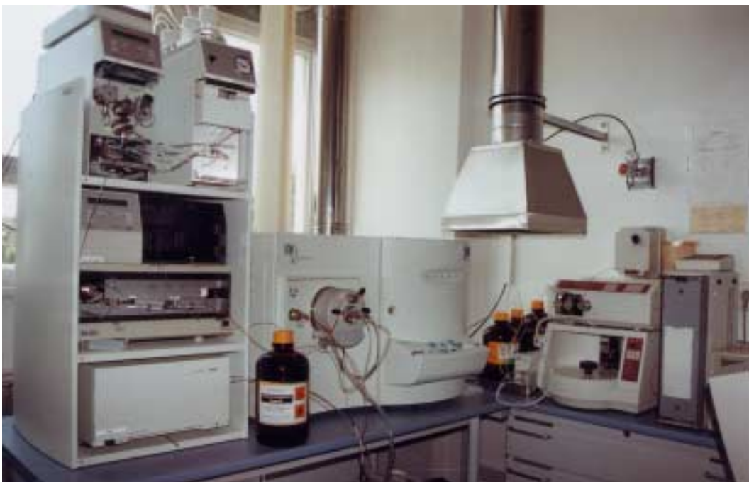
Gerätekombination zur Schwermetallanalytik
