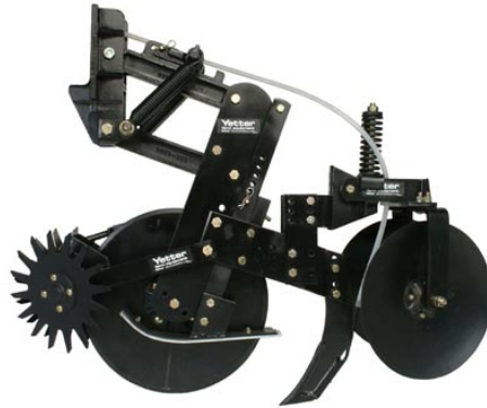
Abbildung 1: Werkzeug zur streifenweisen Bearbeitung des Bodens („strip-till“)
