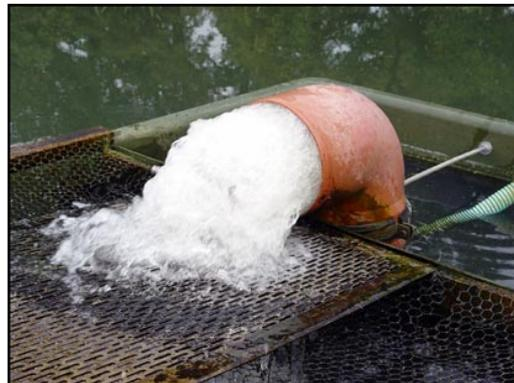
**Abbildung 6: Neukonstruierter HP-Förderer mit einem 90°-Bogen als Auslauf**
