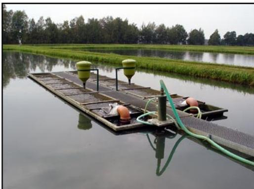
**Abbildung 7: Funktionsfähiges „In-Teich-Kreislaufsystem“**
