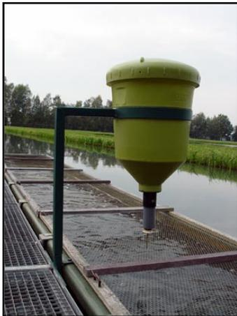
**Abbildung 10:** Elektronisch gesteuerter Futterautomat
