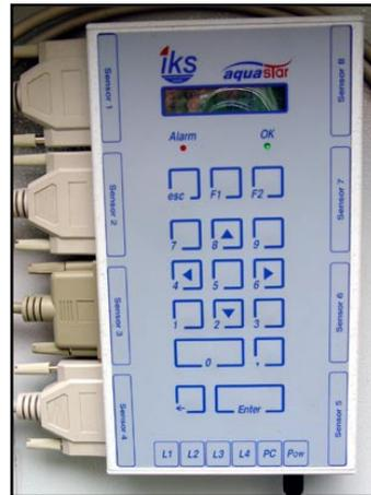
**Abbildung 11:** Sauerstoffmessgerät IKS „AquaStar“
