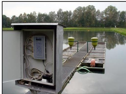
**Abbildung 8: Messstation für Sauerstoffgehalt und Wassertemperatur**
