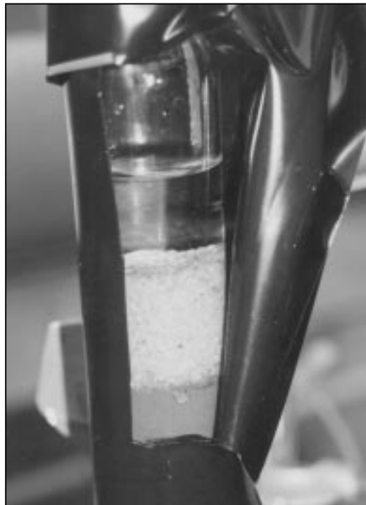
Bildtafel 2: Die Bodensäulen. Für die Langzeitelution wurden die Säulen einschließlich Zu- und Ablauf und der Eluatsammelgefäße lichtdicht ummantelt. Die Elution wurde durch ein verschließbares Kontrollfenster überwacht.
