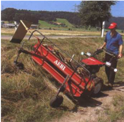
Abbildung 2-72: Hydrocut Aebi HC55 mit Bandrechen [4]
