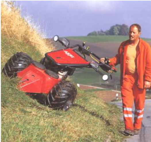
Abbildung 2-63: Hydrocut HC55 mit Mähbalken [4]
