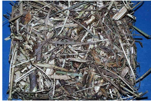
Probe M (Verhältnis Biomasse : Bindemittel = 1 : 0,75; Werdau : Holunder : Esche : Weide : Hackgut = 1 : 1 : 1 : 1 : 1;) sehr locker, beim Biegetest fallen Partikel ab wahrscheinlich zu wenig Bindemittel bei diesem hohen Holzanteil
