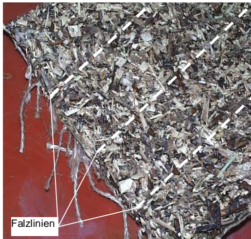
Abbildung 5-23: Baumschutzmanschette aus Heckenschnitt-Häckseln (20 mm) - Detail
