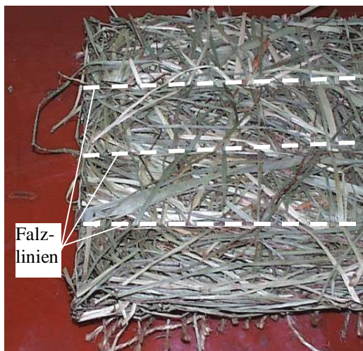
Abbildung 5-27: Baumschutzmanschette aus Schilfgras - Detail
