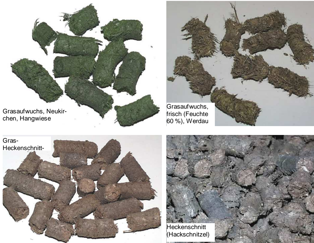
Abbildung 3-23: Mit dem Hohlwalzenpressverfahren hergestellte Presslinge aus verschiedenen Gutarten
