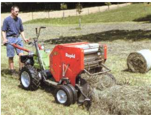
Abbildung 2-74: Ballenpresse, Fa. Rapid [32]
