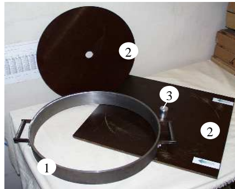
Abbildung 5-8: Werkzeug für Baumscheibe D = 50 cm
