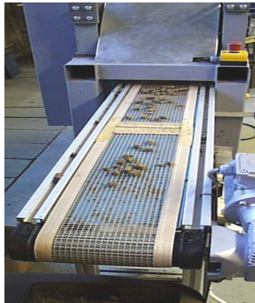
Abbildung 3-21: Profil-Hohlwalzenpresse: Gut- austrag mittels permeablem Fördergurt
