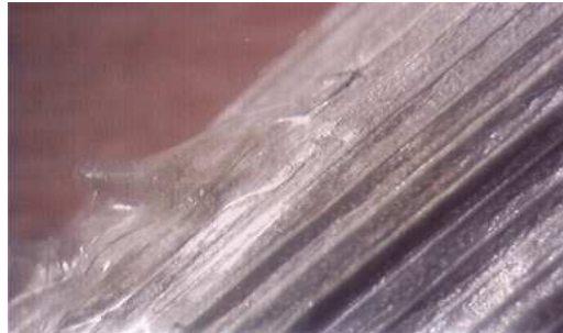
Abbildung 5-13: Schilfgras-Halm mit GIVUL MR überzogen
