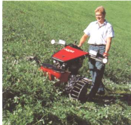
Abbildung 2-64: Hydrocut HC55 mit Mähbalken und zusätzlichem Gitterrad [4]
