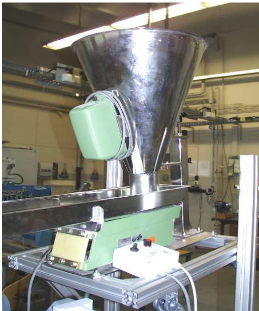
Abbildung 3-20: Zuführtechnik (Vibrationsför- derrinne einschließlich Zwi- schenspeicher für aufbereitete Biomasse)
