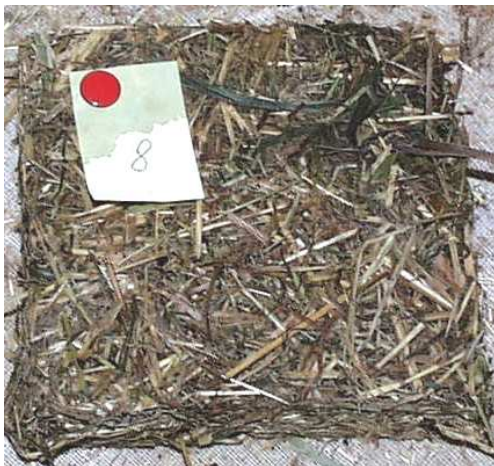
Abbildung 5-18: Probe 8 (Heu) nach kurzzeitiger Lagerung im Wasser
