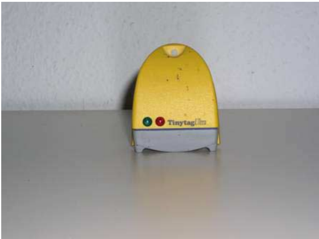
Abbildung 7-9: Temperatur- und Feuchtlogger
