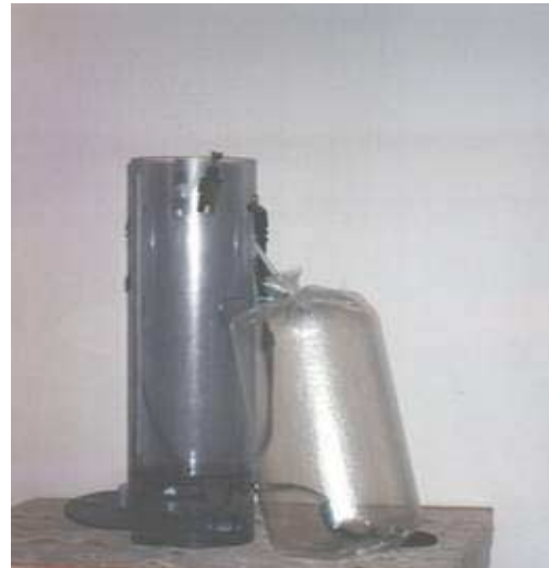
Abbildung 7-8: Probennahmegerät zur Geruchsmessung mit Probenbeutel
