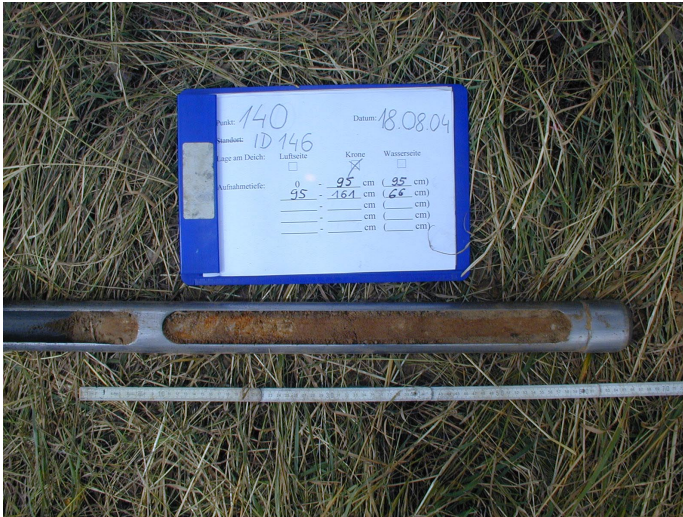
Abbildung 4-1: Beispiel des Ergebnisses einer Rammkernsondierung
