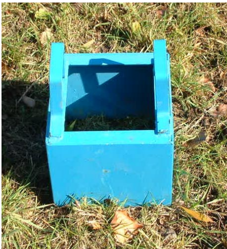
Abbildung 4-5: Stechkasten [Abmessungen 25 x 25 cm]
