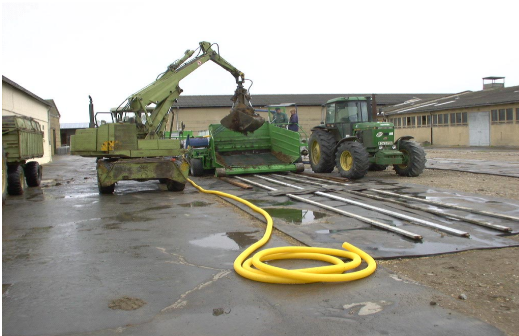
Abbildung 3.1.2-2: Beschickung mittels Kran
