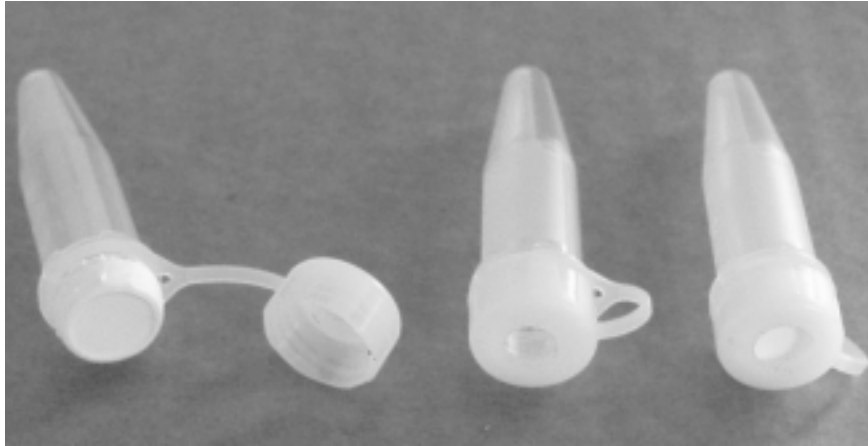
Abbildung 3: Diffusionskeimträger aus Eppendorf - Reaktionsgefäß "Safe Twist" mit anhängendem Schraubdeckel
