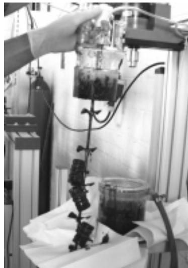
Abbildung 8: Einsetzen der Diffusionskeimträger in die Zwischenräume der Rührelemente der Laboranlage
