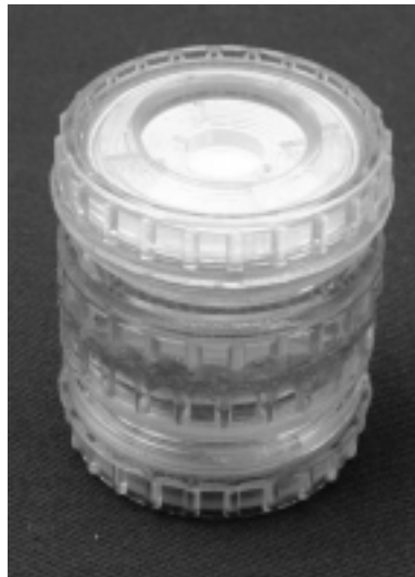
Abbildung 1: Modifizierter Diffusionskeimträger nach RAPP
