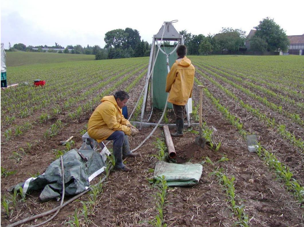
**Abbildung 12: Bodenabtrags- und Infiltrationsmessung mit Beregnungsanlage**
