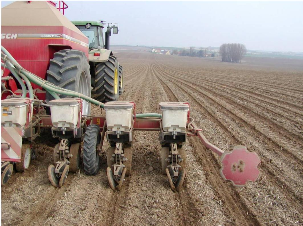
**Abbildung 10: Maisaussaat in streifenweise konservierend bearbeiteter Ackerfläche**
