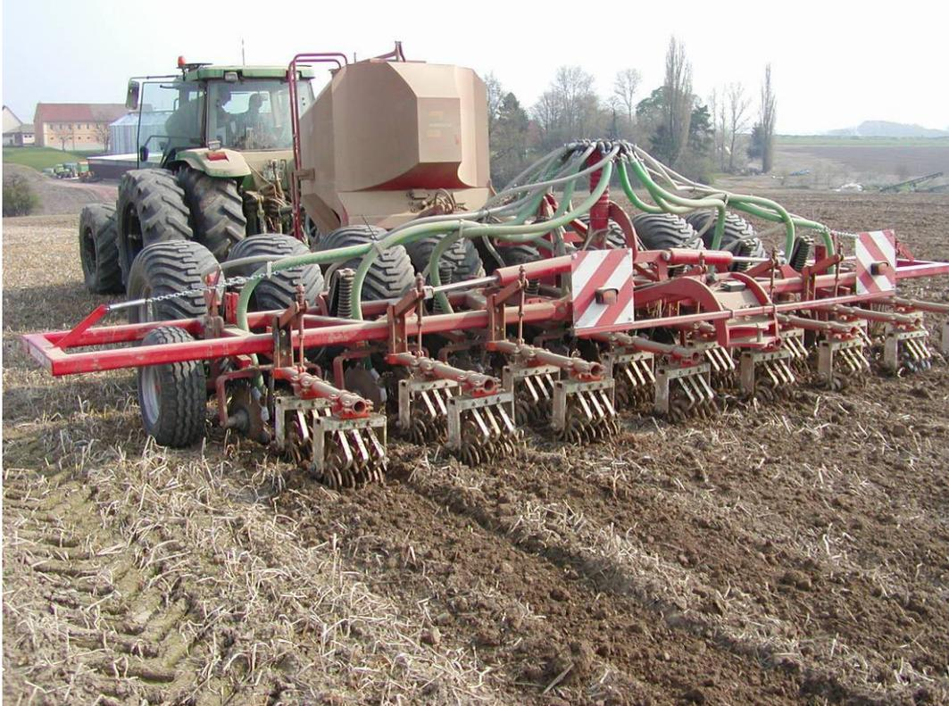
**Abbildung 9: Streifenweise konservierende Bodenvorbereitung im Strip-till-Verfahren zur Vorbereitung der Aussaat von Körnermais**
